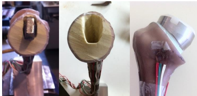
Figura 72 – Utilização da ferramenta, cavidade obtida para receção do cimento ósseo e implante cimentado
