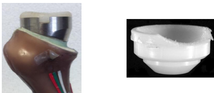
Figura 96 – Vista posterior do úmero implantado (experimental) com especial destaque para o desgaste da componente de polietileno à direita. Desgaste da componente de polietileno (direita) relatado como complicação deste tipo de prótese [108]
