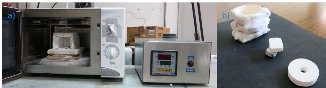
Figura 2.3- Forno de microondas de cozinha adaptado. a) Cubo de alumina posicionado dentro da cavidade, controlador de temperatura à direita. b) Cadinho de alumina, barra de SiC e tampa.
