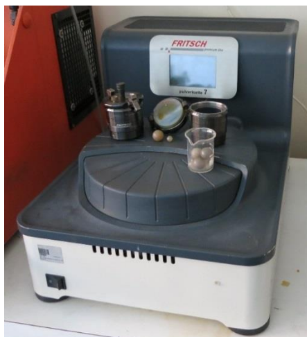
Figura 2.2- Moinho pulverisette 7 utilizado para a mistura e moagem dos reagentes no processo de ativação mecânica.
