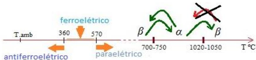
**Figura 1.3** Esquema representativo das alterações, físicas e de fase, do  $\text{BiNbO}_4$ .
