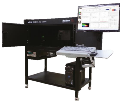
Figura 8 - Fotografia do SIC M6100 OLED I-V-L Test System da McScience [28].
