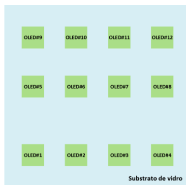
Figura 25 - Esquema da configuração dos dispositivos no substrato de 150x150 mm (em proporção).
