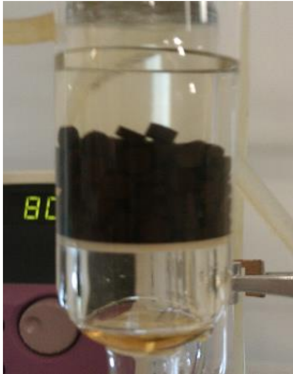
Figura 11: Pastilhas de resíduo de café feitas utilizando uma prensa manual no interior de uma montagem Soxhlet.
