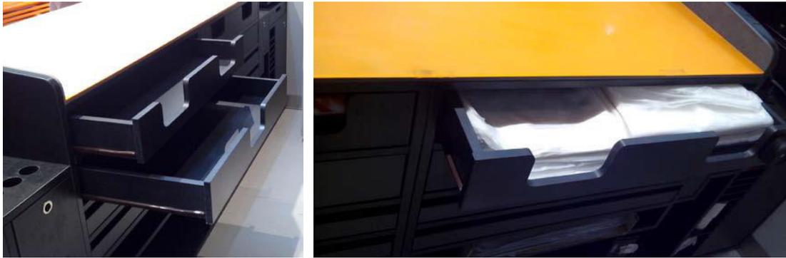
Fig. 64 e 65 – As gavetas não tinham profundidade suficiente para comportar os sacos da Sport Zone. Como não estavam micro perfuradas, impossibilitavam a entrada de divisórias.
