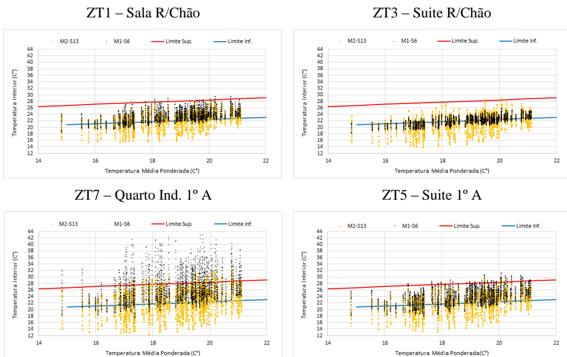
Figura 66 – Análise de conforto segundo EN15251 [43] para a estação de arrefecimento, comparação entre o modelo M1-S6 e o modelo M2-S13
