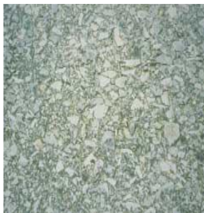
Figura 14 - Polimento de agregados (Miller & Bellinger, 2003)
