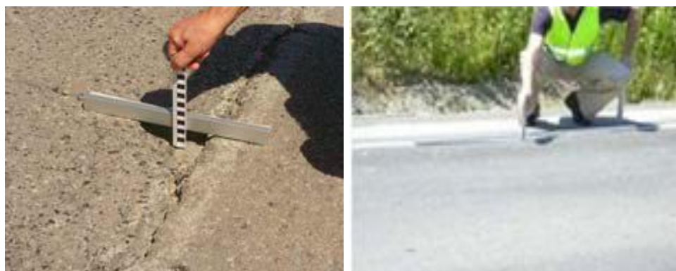
Figura 2 - Abatimento transversal e longitudinal, respetivamente (Alves, 2007)
