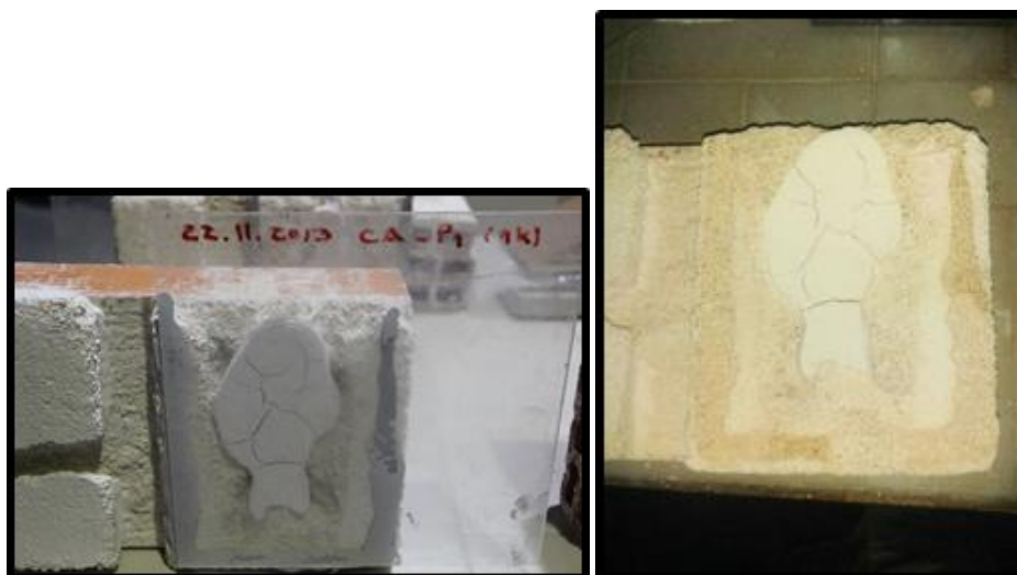
Figura 40 – Calda de injeção de cal aérea com fissuras após alguns minutos de secagem
