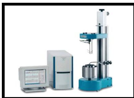
Figura 18 – Reómetro utilizado na avaliação reológica de argamassas (Viskomat NT)
