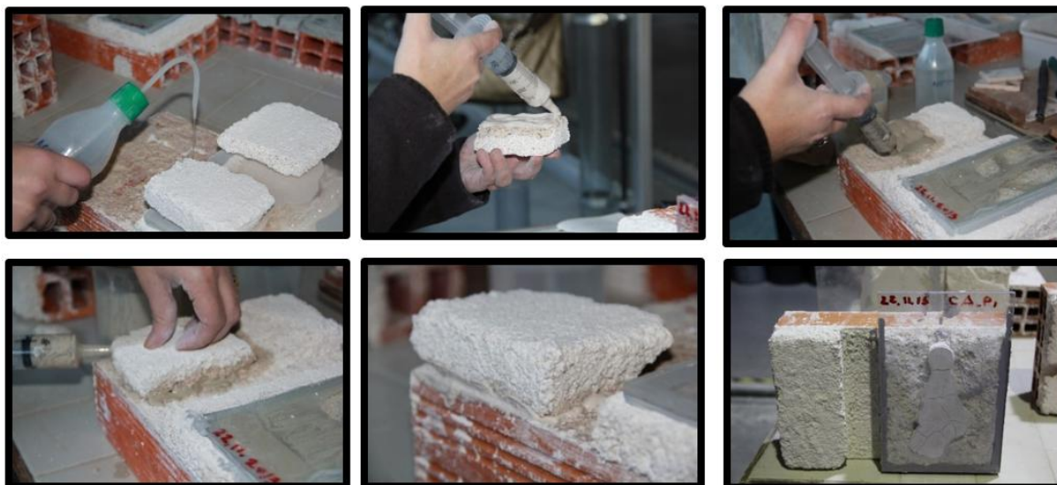
Figura 24 – Processo de colagem com as caldas de injeção dos seguintes provetes A1, A2, B e C
