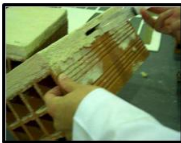
Figura 9 – Provetes simulando descolamento entre camadas (Tavares et al., 2007)
