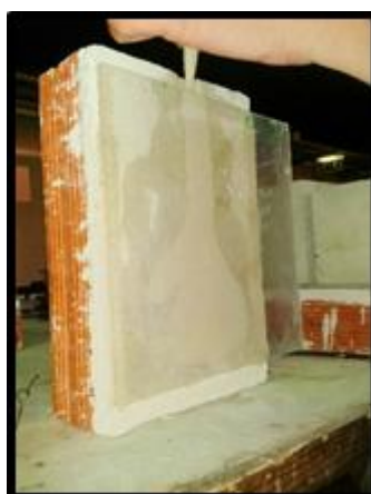
Figura 54 – Calda de injeção de cal aérea com os espaços vazios todos preenchidos
