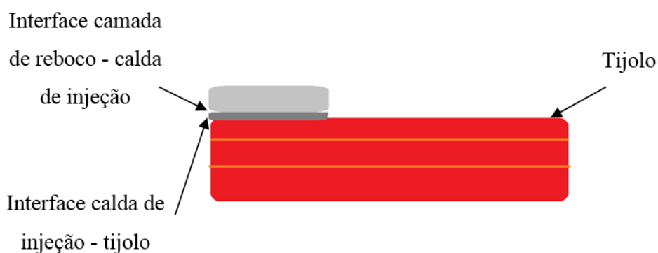
Figura 27 – Esquema representativo do tipo de bloco em estudo, onde se descreve as diversas interfaces existente
