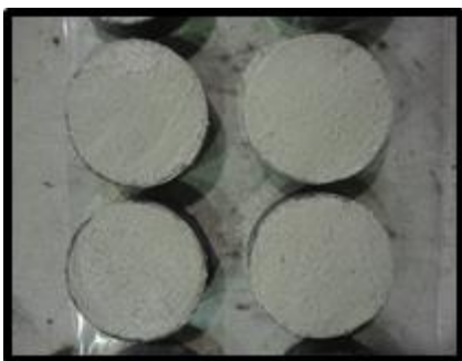
Figura 28 – Provetes cilíndricos para utilização no ensaio de aderência
