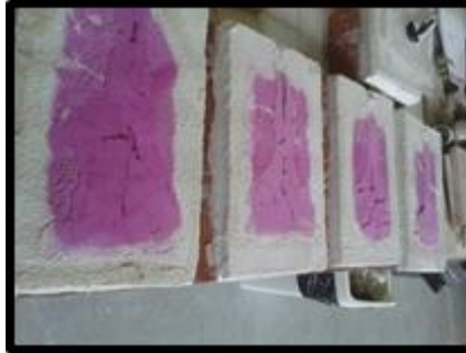
Figura 33 – Ensaio com fenolftaleína nos provetes de tijolo
