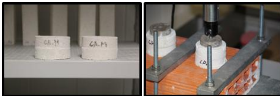
Figura 31 – Provetes cilíndricos pulverizados 4 em 4 dias em toda a superfície
