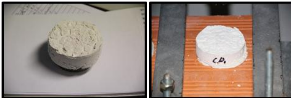
Figura 63 – Tipo de rotura coesiva com a argamassa pulverizada
