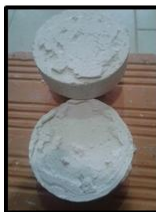
Figura 62 – Amostra circular de argamassa de cal aérea com calda de injeção de cal aérea, com rotura coesiva
