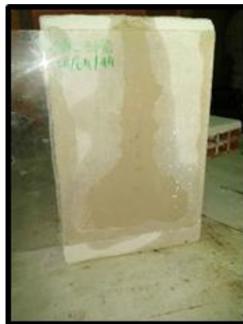
Figura 56 – Calda de injeção de cal hidráulica com os espaços vazios todos preenchidos
