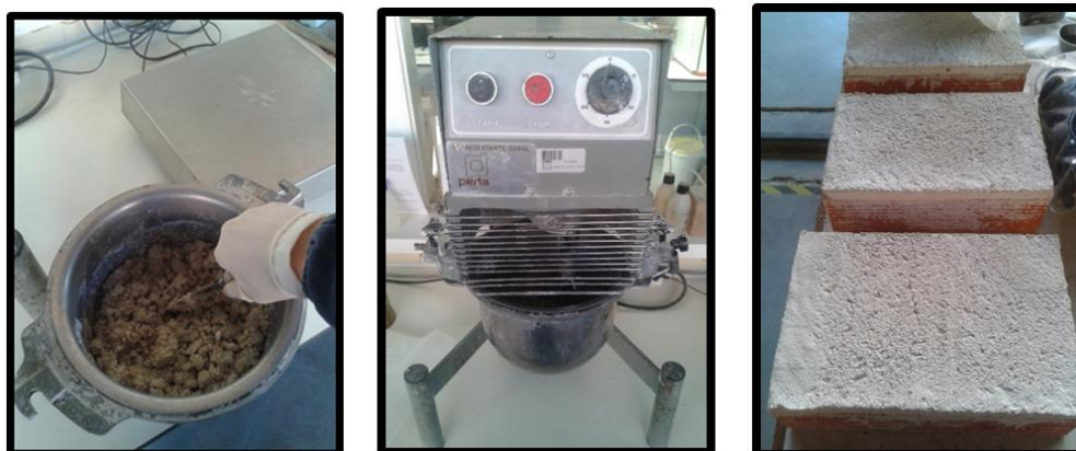
Figura 16 - Esquema de preparação das argamassas de suporte AR e AM
