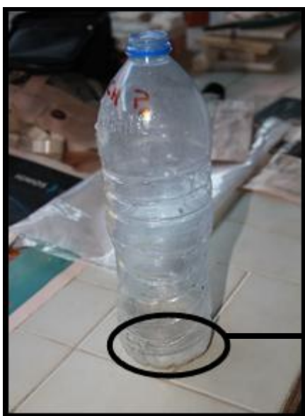
Figura 35 – Calda de injeção de cal hidráulica num recipiente com sedimentação no fundo
