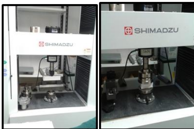
Figura 22 – Máquina de ensaio mecânico (à flexão e à compressão)
