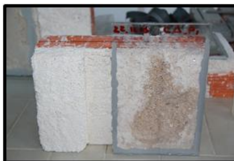
Figura 12 – Argamassa com molhagem antes da injeção da calda de injeção
