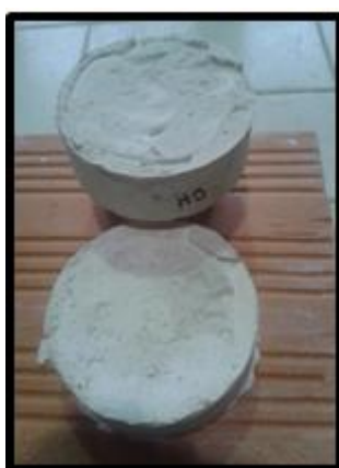
Figura 61 – Amostra circular de argamassa de cal aérea com calda de injeção de cal hidráulica, rotura adesiva
