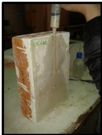
Figura 55 – Introdução da calda de injeção de cal hidráulica
