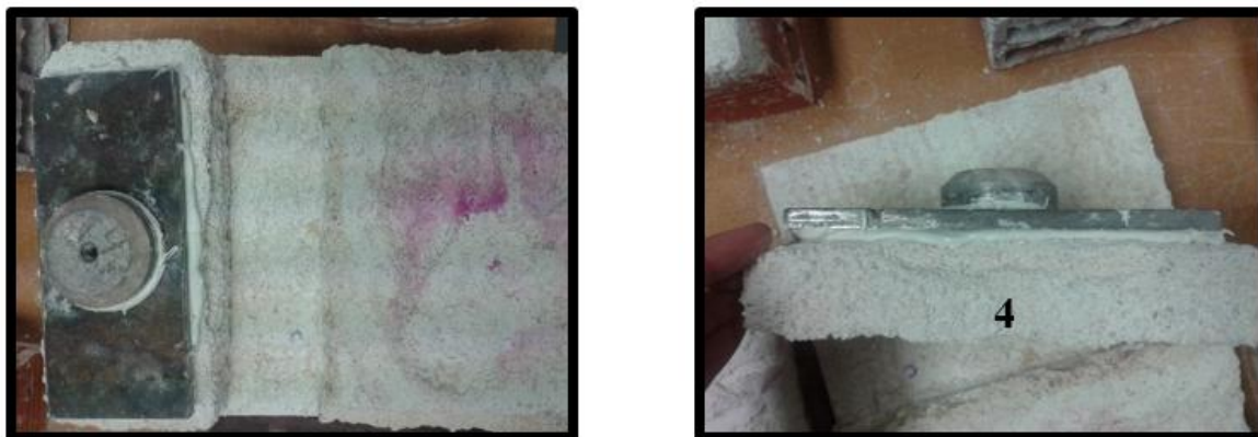
Figura 58 – Rotura adesiva na amostra 4
