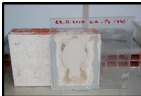
Figura 39 – Calda de injeção de cal aérea muito espessa não conseguindo preencher todos os espaços vazios.
