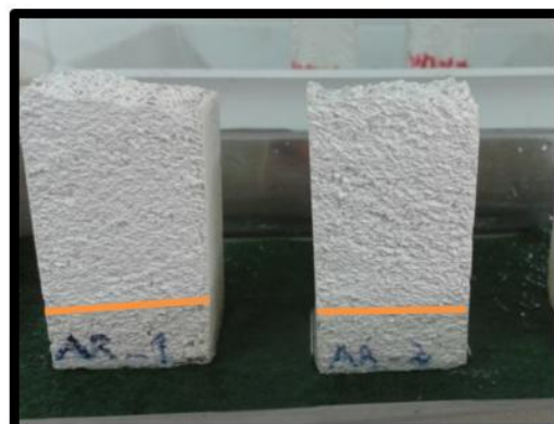
Figura 52 – Medição do coeficiente de capilaridade de AR
