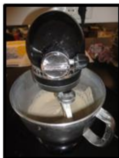
Figura 17 – Mistura dos materiais sólidos com a água na misturadora
