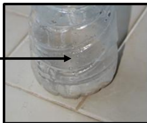
Figura 36 – Pormenor da sedimentação da calda de injeção de cal hidráulica
