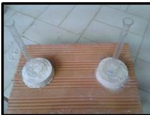
Figura 64 – Tubos de Karsten, para o ensaio de permeabilidade à água sob baixa pressão
