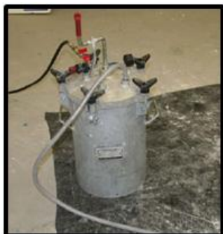
Figura 7 – Equipamento de injeção “ pressure pot ” (Luso, 2007)
