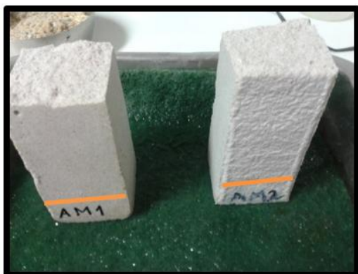
Figura 51 – Medição do coeficiente de capilaridade de AM
