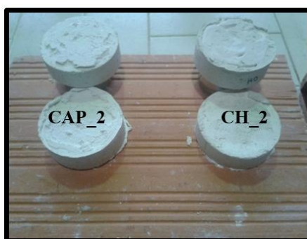
Figura 60 - Provetes circulares de cal aérea com calda de injeção de cal aérea e hidráulica com rotura coesiva
