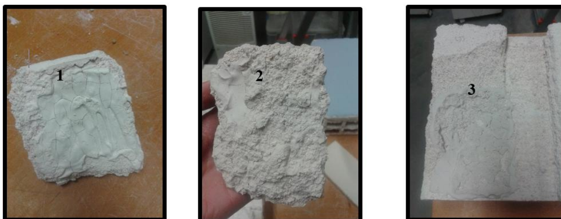
Figura 57 - Tipo de rotura coesiva das amostras 1, 2 e 3 da tabela 9
