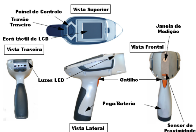
Figura 57 - Analisador por fluorescência de Raios X (XRF) NITON XL3t 900 (NITON, 2011).
