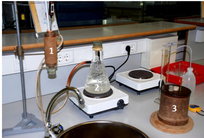
Figura 71 - Equipamentos de ensaio: 1- Estufa; 2 – Ebulidor e fonte de calor; 3 – Calorímetro.
