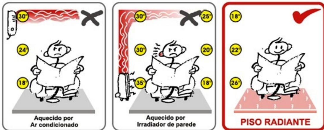
Figura 78 - Comparação entre os vários sistemas de aquecimento convencionais e o piso radiante. ( http://www.emporioluxo.com.br/imgdesc/1.jpg , 2013)
