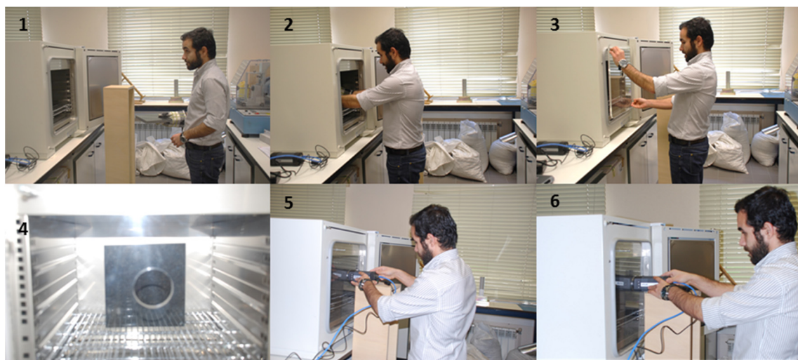
Figura 77 - Procedimento do ensaio. 1 e 2- Colocação do provete aquecido na estufa-caixa na posição de leitura; 3- Colocação da placa de acrílico; 4 - Rocha dentro da estufa-caixa; 5 e 6 - Posicionamento do cavalete e da câmara à distância de filmagem.
