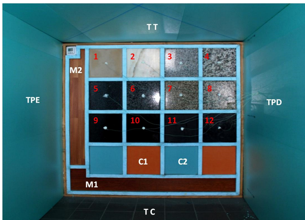
Figura 93 - Aspecto do interior da casa térmica e esquema dos termopares.
