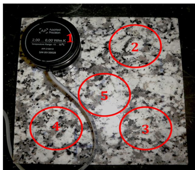
Figura 69 - Posição da sonda para as 5 medições efetuadas em cada provete.
