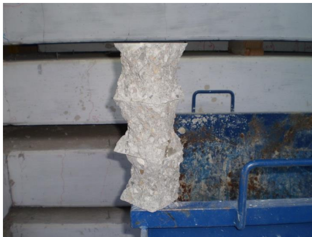
Figura 3.12- Exemplo de provetes com a rotura correcta
