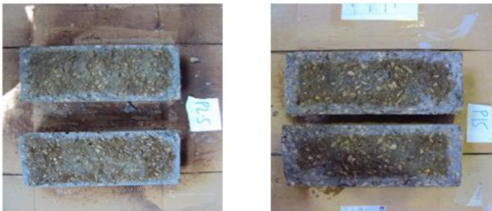
Figura 4.34- Efeito do teor em cimento na durabilidade
