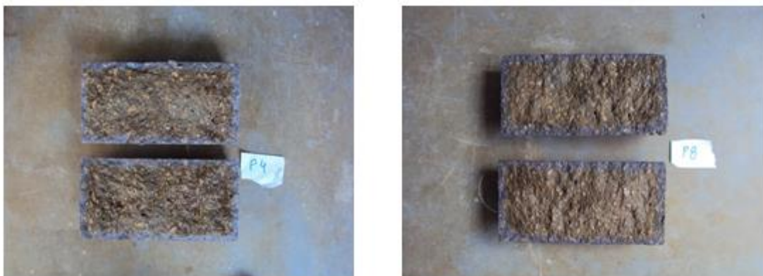
Figura 4.32- Efeito da razão A/C na durabilidade
