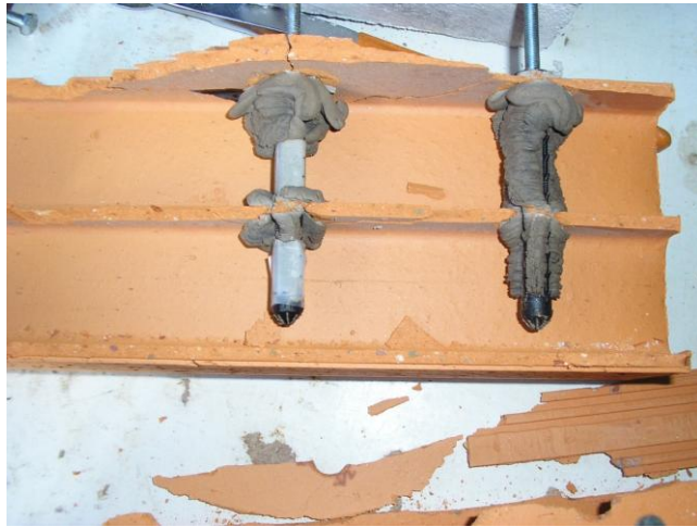
Figura 41: Manipulação do bolbo (com manipulação à esquerda e sem à direita)
