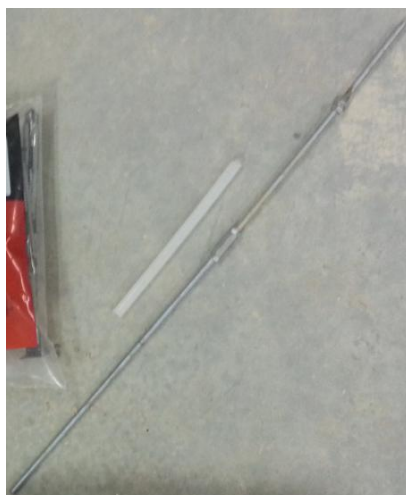
Figura 36: Ferramenta auxiliar para posicionamento da manga
