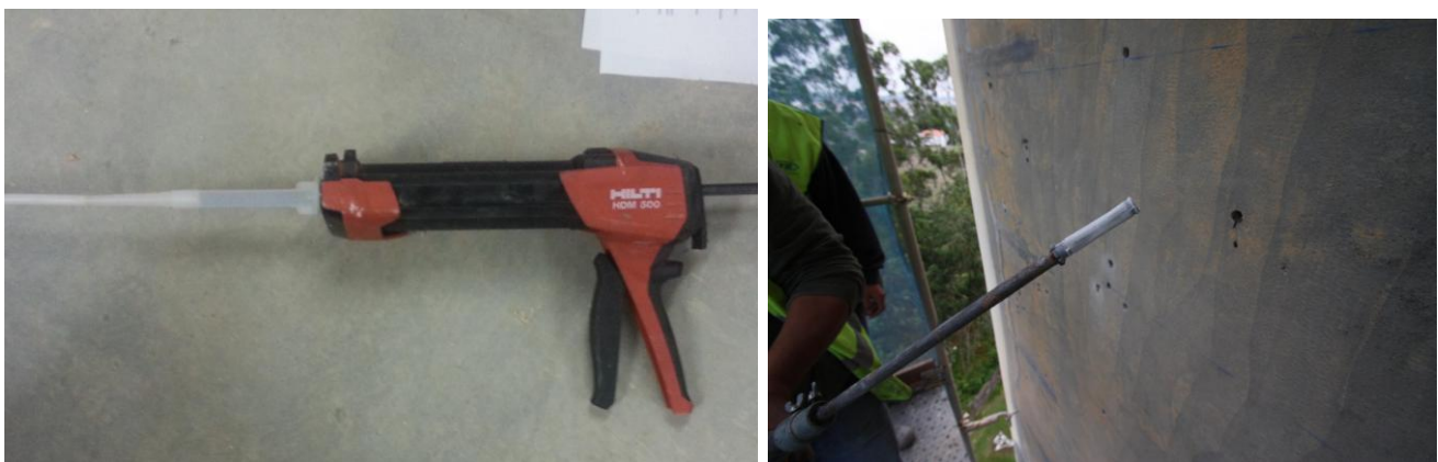
Figura 35: a) Pistola de injeção da Hilti com ponta de plástico b) Pistola Helifix ponta metálica
