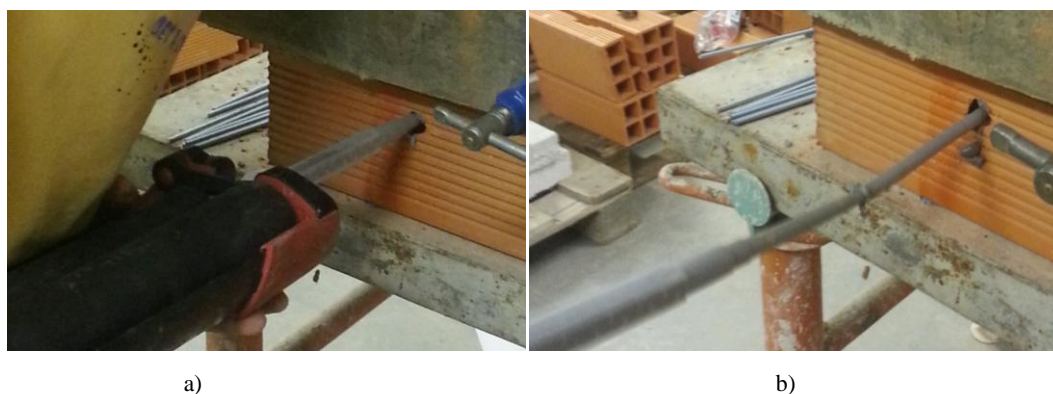
Figura 60: Processo de enchimento das mangas no pano interior (a) e exterior (b)
