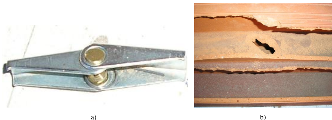
Figura 51: a) Bucha tipo mola M4 b) Tipo de rotura no septo
