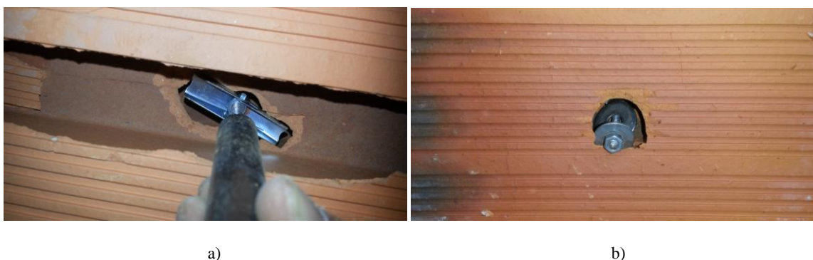
Figura 80: Combinação Mec-M: a) Rotura tijolo de formato 30x20x11 b) Rotura tijolo de formato 30x20x15
