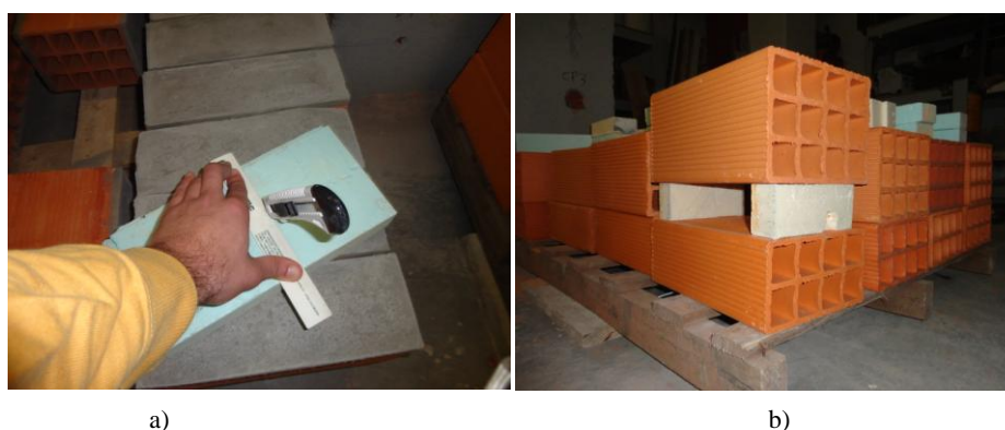
Figura 32: a) Elaboração de espaçadores em XPS b) Provete com espaçadores XPS
