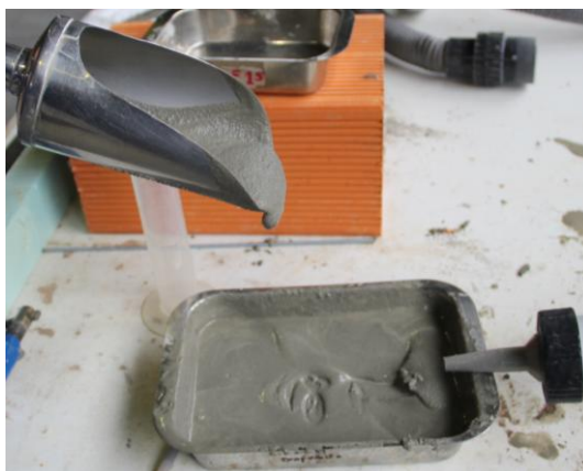
Figura 50: Consistência final da argamassa
