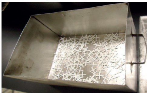
Fig. 64 - Recipiente para ebulição com cruzetas no fundo
