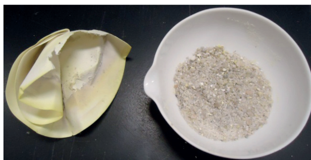
Fig. 60 - Insolúveis separados do filtro
