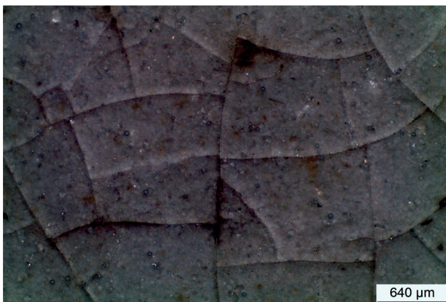
Fig. 95 - Visualização plana do azulejo, com o vidro, microfissurado (Foto escurecida, para permitir melhor verificar o craquelé)
