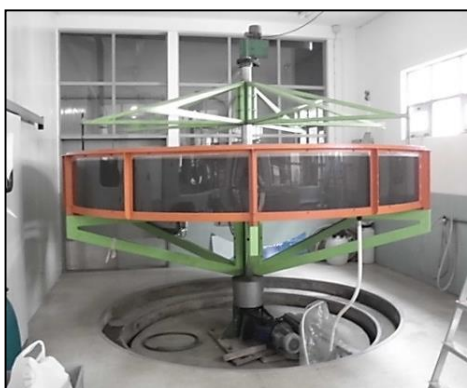
a) Vista geral do canal anular
