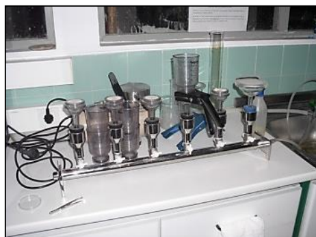
a) Equipamento de filtração
