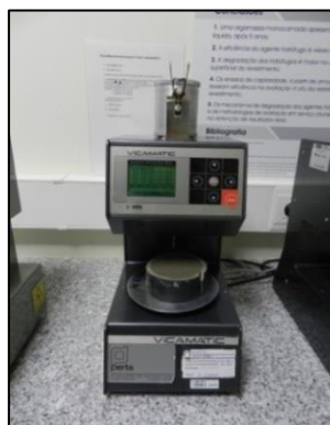
Figura 4.4 - Equipamento de VICAT para determinação do tempo de presa
