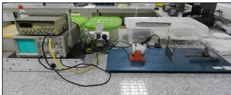
Figura 4.13 - Equipamento de medição da frequência de ressonância
