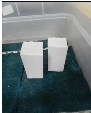
Figura 4.14 – Provetes dentro do recipiente de ensaio de absorção de água por capilaridade
