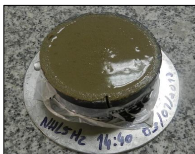
Figura 5.3 – Exemplo de ausência de retenção de água por parte da argamassa NHL5.M2
