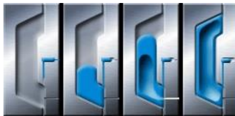
Figura 2. Variante short shot da moldação assistida a gás [4]
