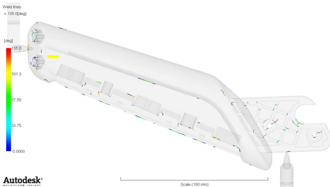
Figura 40. Linhas de soldadura do modelo numérico
