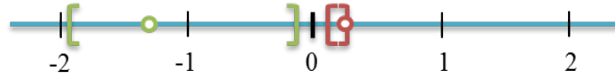
Figura 3.14: Estado do algoritmo no exemplo A após a primeira situação de consumo. M^{(C)} = -1.316 ; M^{(NC)} = 0.203 ; L_1^{(C)} = -1.924 ; P_1^{(C)} = 2 ; L_2^{(C)} = -0.1 ; P_2^{(C)} = 1 ; L_1^{(NC)} = 0.1 ; P_1^{(NC)} = 32 ; L_2^{(NC)} = 0.219 ; P_2^{(NC)} = 208 ; W^{(C)} = 2 ; W^{(NC)} = 239 .
