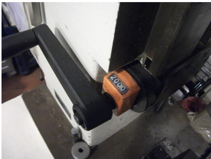
Figura 35 - Manípulo de afinação de altura de trabalho
