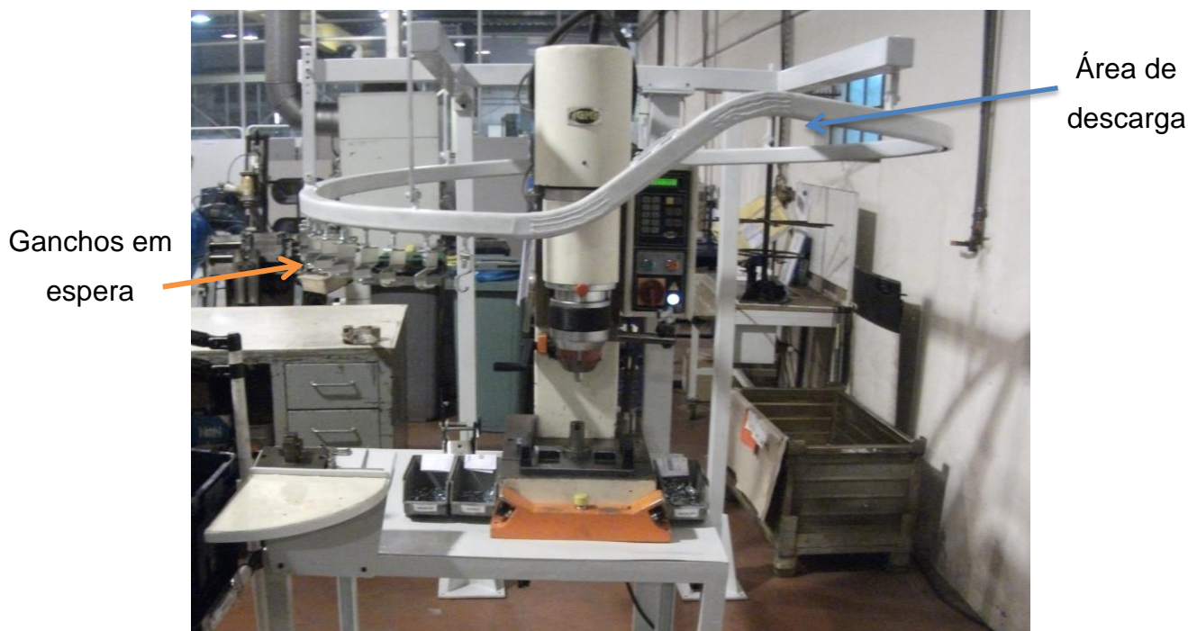
Figura 70 - Vista de frente da calha de transporte
