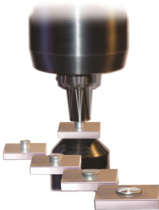
Figura 7 - Esquemática do processo de rebitagem ( www.orbitform.com )
