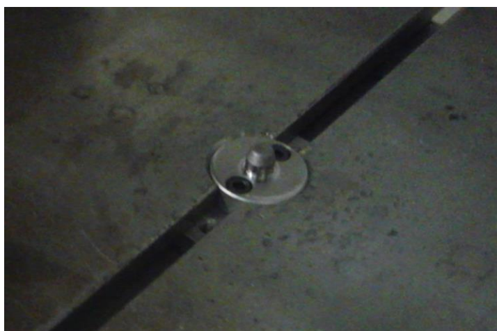
Figura 51 - Pino centrador de ferramentas
