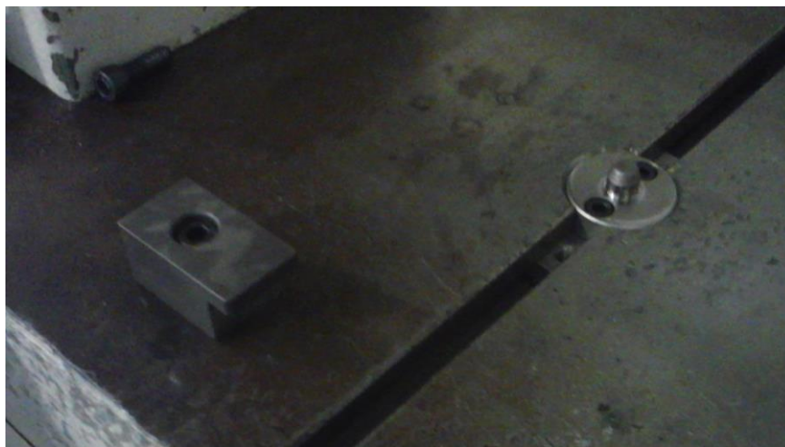
Figura 52 - Pino centrador e dispositivo anti rotação.
