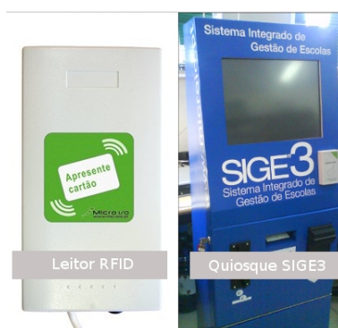
Figura 2.6: Quiosque SIGE3 com leitor RFID[17]
