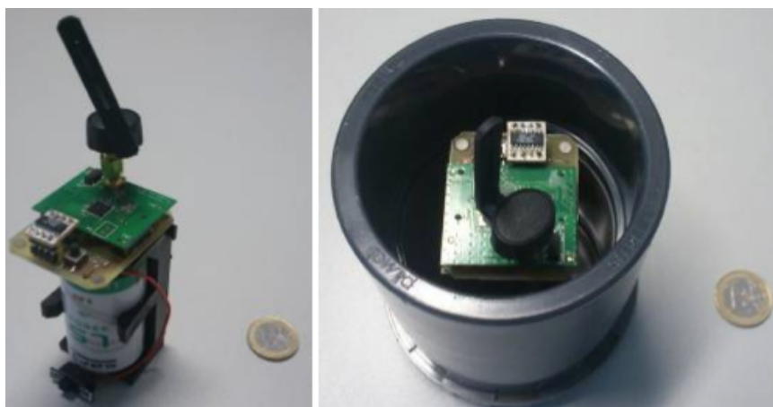
Figura 2.11: Protótipo do sensor desenvolvido para monitorização do tráfego [20]
