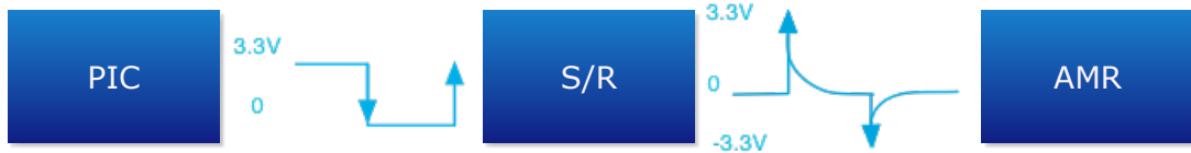
Figura 3.15: Processamento de sinal para realinhamento do sensor
