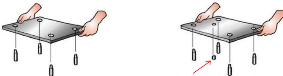
Figura 5 - Exemplo de mecanismo Poka-Yoke
