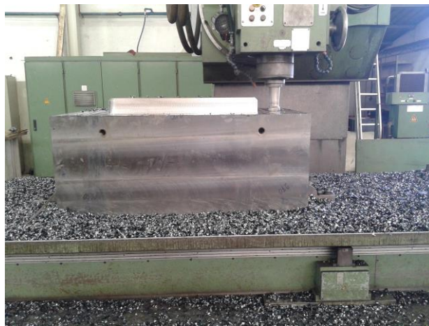
Figura 20 - Fresagem dos blocos de aço
