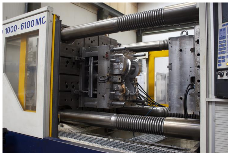
Figura 24 - Máquina de injeção
