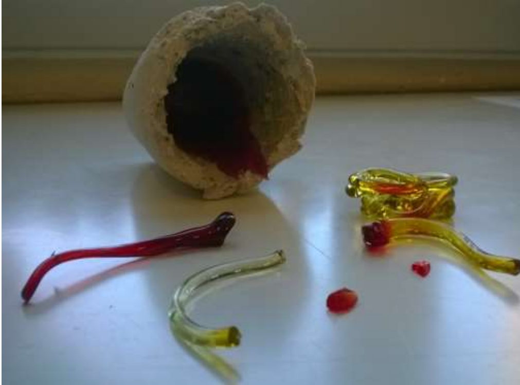
Figura 29 - Diferentes cores obtidas numa fusão da composição Zn12
