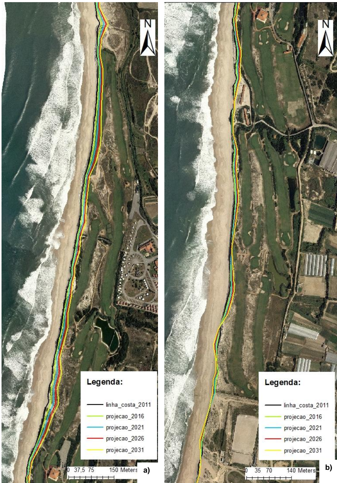
Figura 20 - Projeção da linha de costa para 2016, 2021, 2026 e 2031 na freguesia da Estela. a) Zona norte do campo de golf; b) zona sul do campo de golf.
