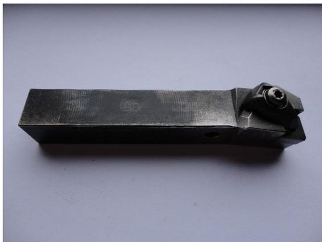
Figura 25 - Porta-ferramentas utilizado nos ensaios de torneamento
