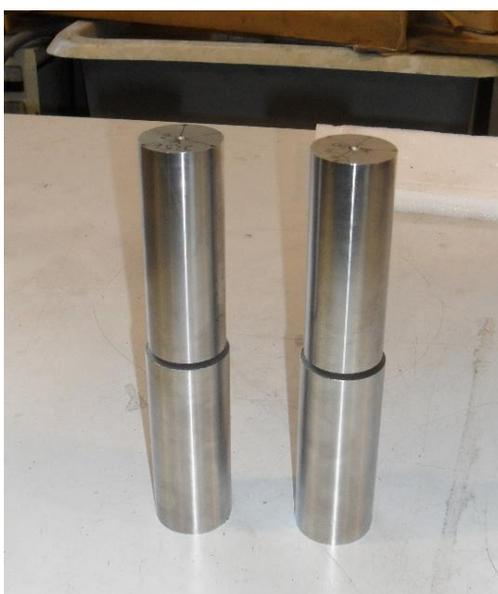
Figura 24 - Provetes de aço AISI H13 utilizados.
