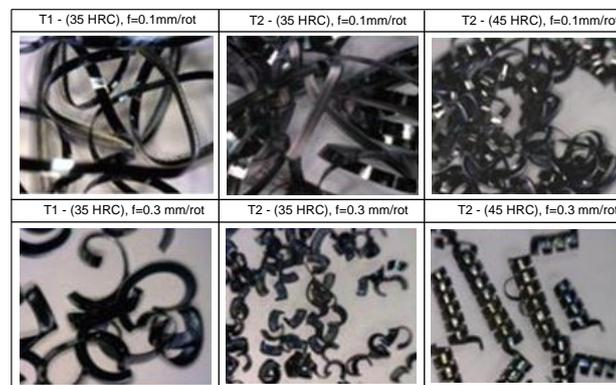
Figura 11 - Tipos de apara obtidos com diferentes parâmetros de corte e diferentes tipos de ferramenta: T1 - pastilha de carbonetos com revestimento PVD de TiAlN; T2 - pastilha de carbonetos com revestimento CVD.(Chinchanikar and Choudhury, 2013) (adapt.)
