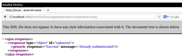
Figura 3.16: Exemplo de AMI sobre HTTP com resposta em XML
