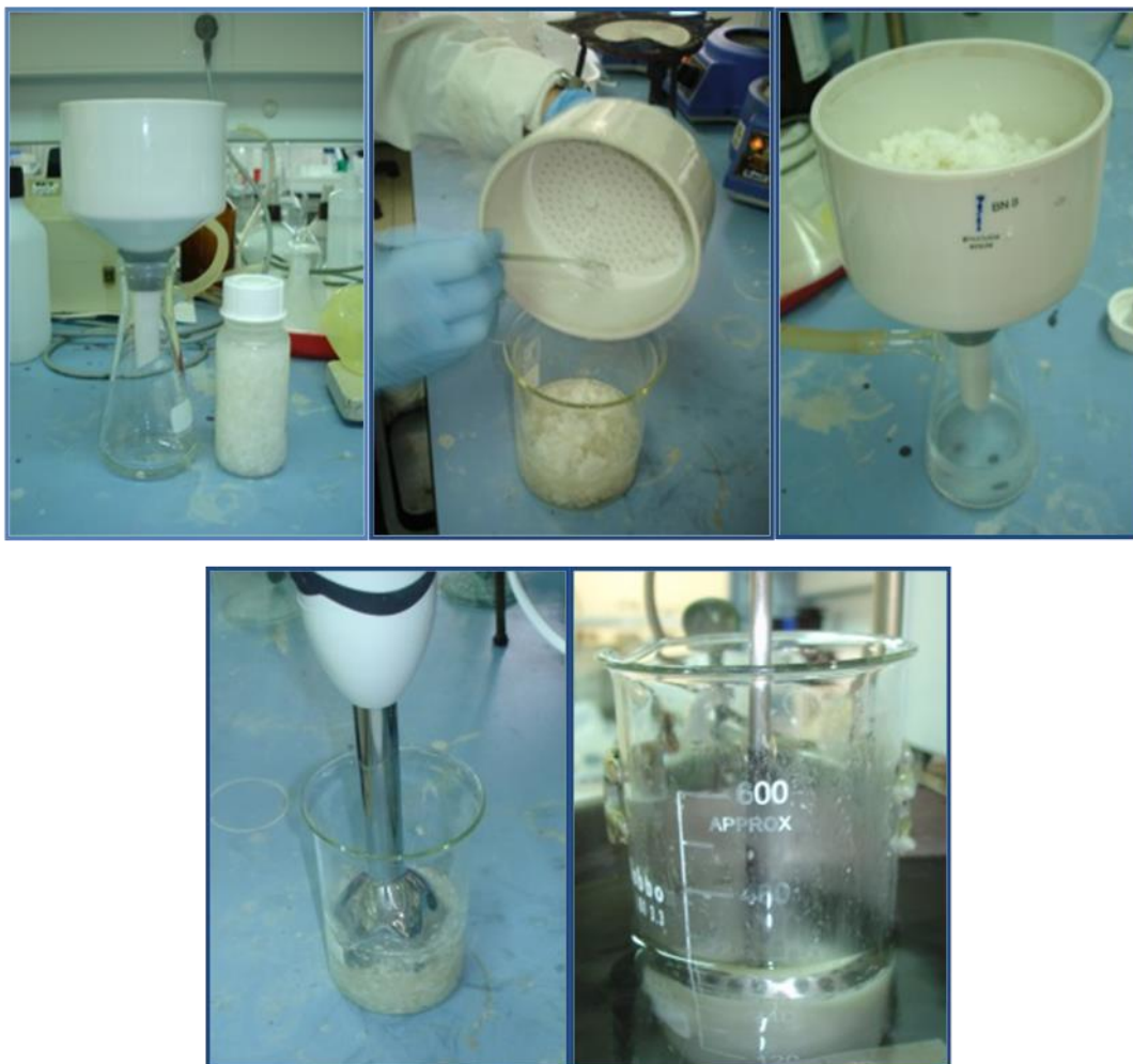
Figura 15: Sequência laboratorial simplificada da extração alcalina.
