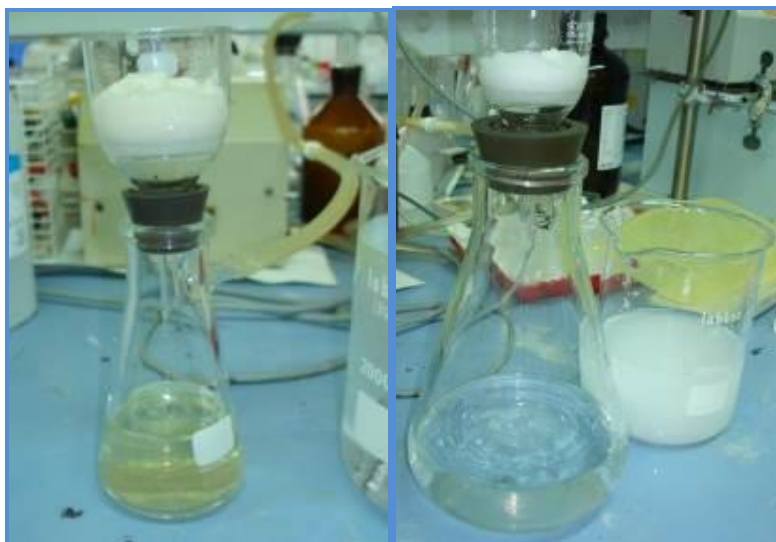
Figura 16: Exemplo de material (filtrado e pasta) + extraído após extração alcalina com um tempo definido (2 horas).
