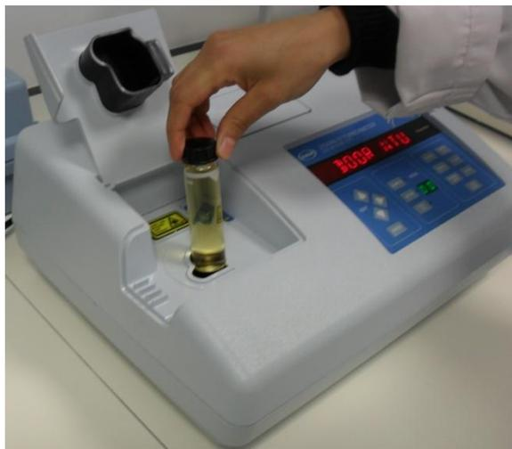
**Figura 21** Turbidímetro.
