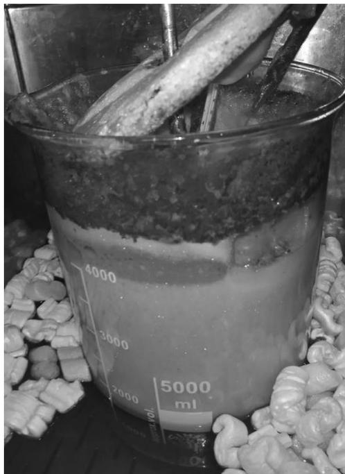
**Figura 28** – Solução final da hidrólise enzimática com a Celluclast 1,5L.
