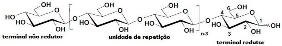
Figura 3 – Estrutura molecular da celulose. Adaptado de (Sixta, 2006).
