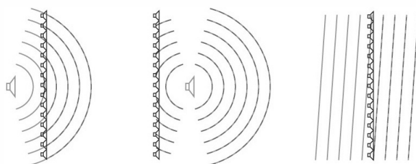
Figura 4.11. Reprodução de diferentes fontes por um sistema de WFS (Baalman, 2010).
