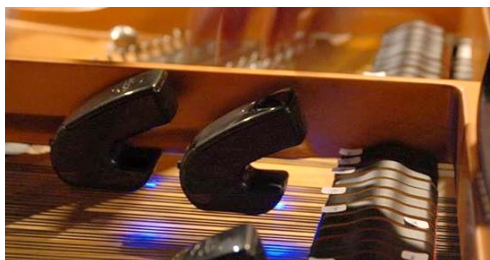
Figura 6.14. EBows sobre as cordas do piano.
