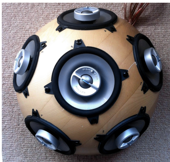
Figura 2.33. Réplica, construída para obra com título longo * [2009], da coluna hemisférica desenvolvida para a SLOrk.
