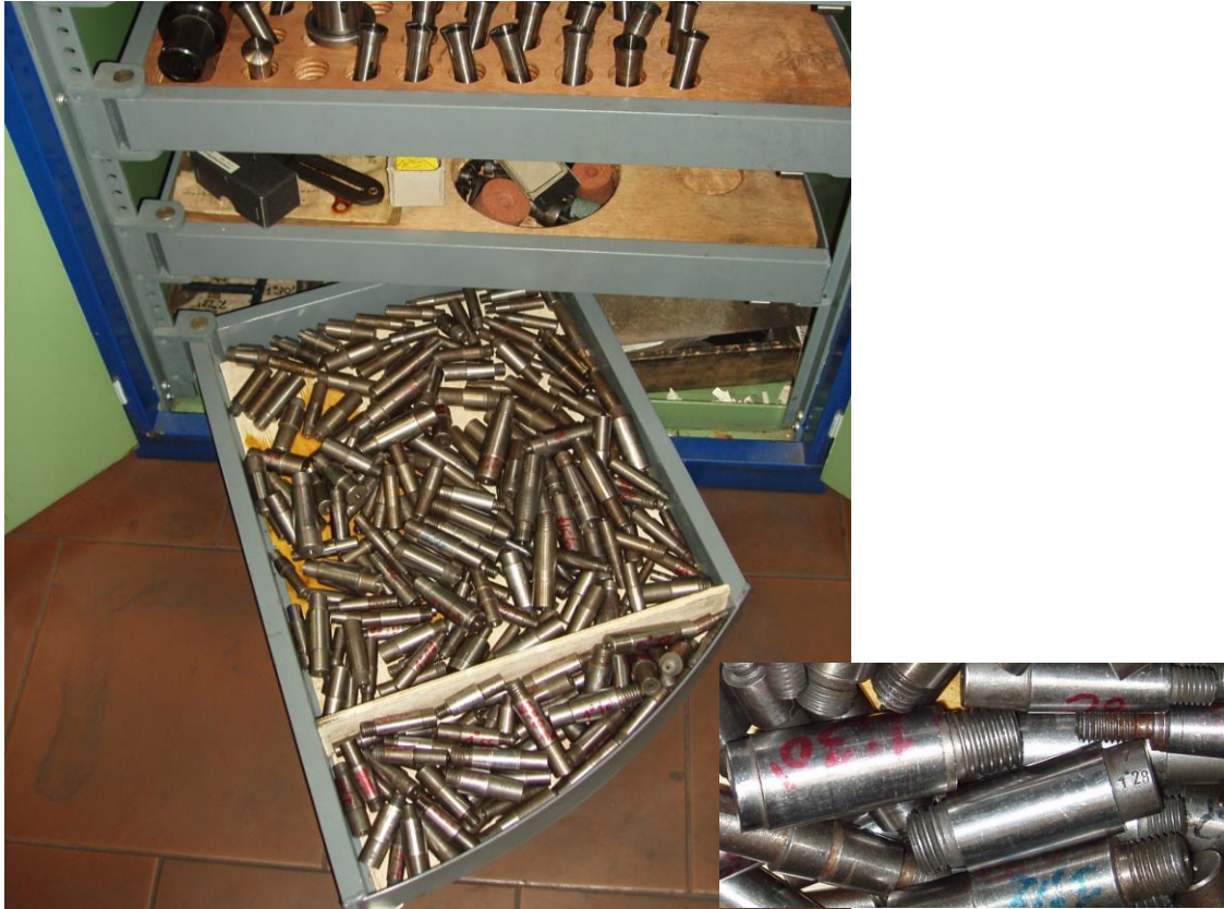
Figura 30 – Armário com a separação e identificação das buchas para a retificação cilíndrica.
