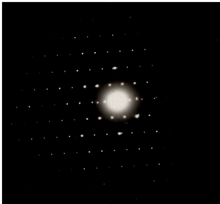
Figura 3.29 – Imagem da difracção de electrões de nanocristais de \text{Bi}_2\text{S}_3 , preparados por pirólise a seco, usando como precursor o [\text{Bi}(\text{S}_2\text{CNMe}^n\text{Oct})_3] durante 4 horas a 230^\circ\text{C} .
