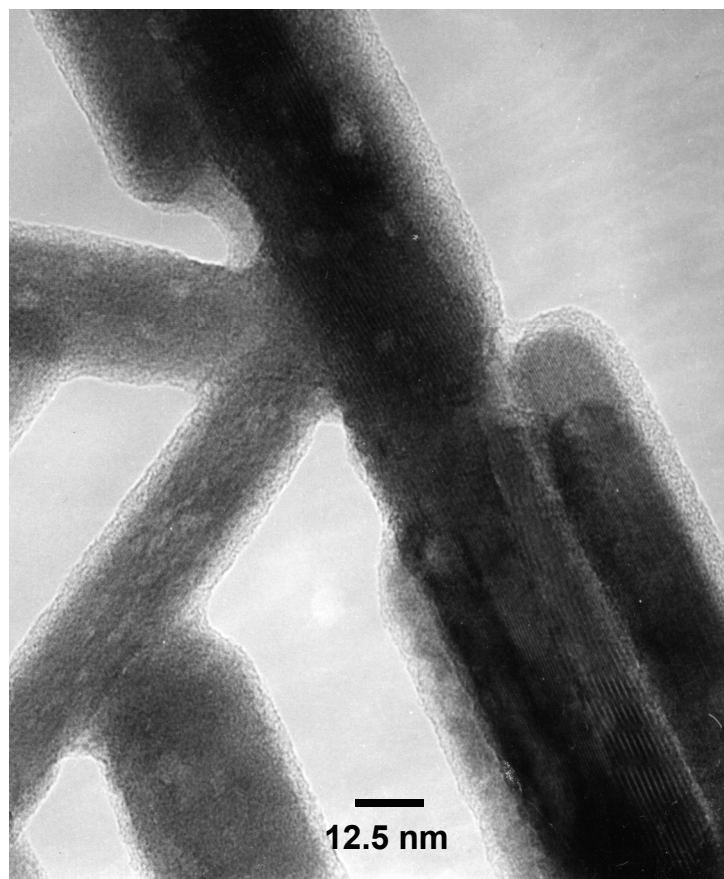
Figura 3.25 – Imagem de HRTEM de nanopartículas de \text{Bi}_2\text{S}_3 preparadas por decomposição térmica do precursor [\text{Bi}(\text{S}_2\text{CNMe}^n\text{Hex})_3(\text{C}_{12}\text{H}_8\text{N}_2)] em etilenoglicol a 198^\circ\text{C} .
