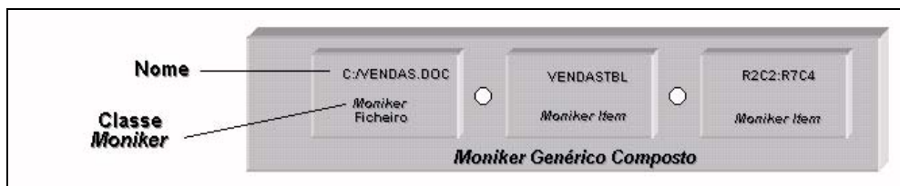
Figura 50 - Moniker composto constituído por um moniker ficheiro e dois monikers item. Descreve a fonte de ligação, a qual é um intervalo de células numa folha específica de um ficheiro folha de cálculo.
