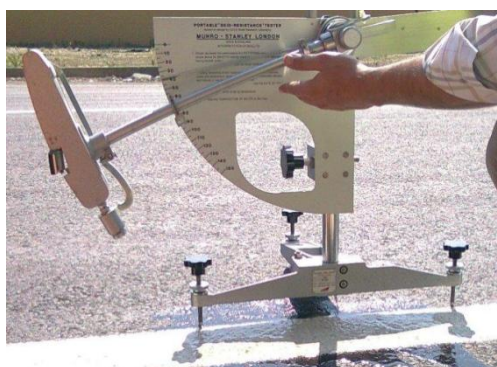
Figura 5.28 - Ensaio do pêndulo Britânico (foto da autora)
