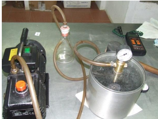
Figura 5.20 - Ensaio para determinação da BMT (foto da autora)
