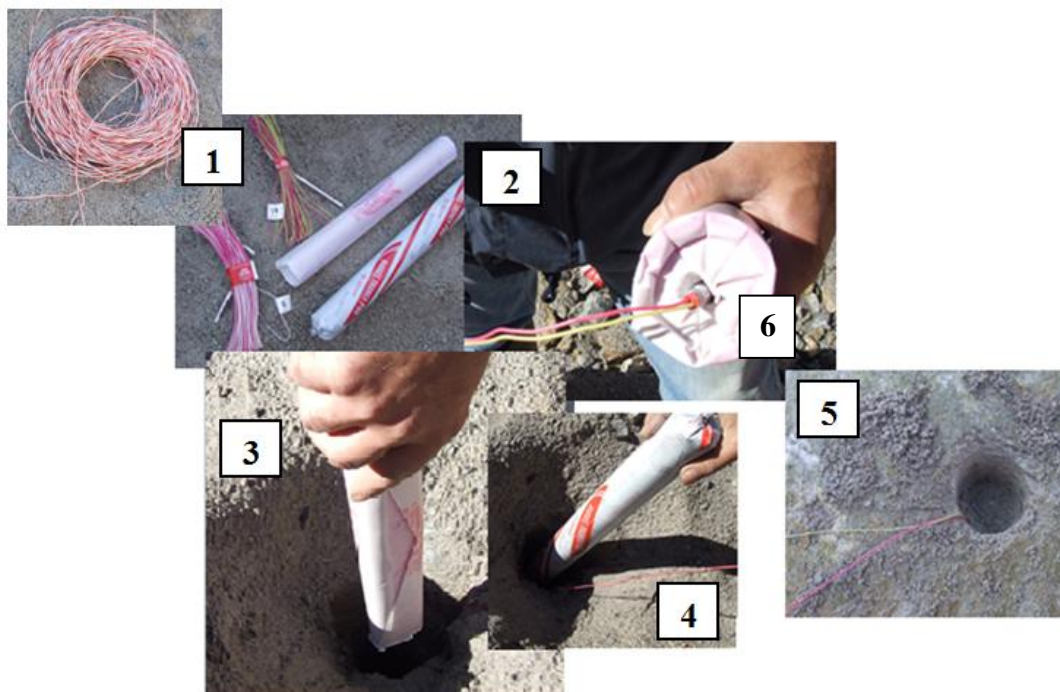
Figura 2.7 - Material explosivo utilizado e etapas de carregamento de um furo (foto da autora)
