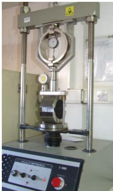
Figura 5.21 - Prensa Marshall (foto da autora)
