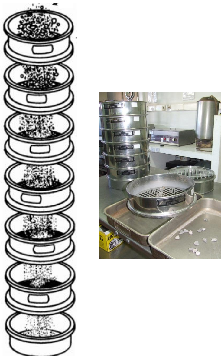
Figura 5.7 - Esquema representativo de uma seqüência de peneiros (adaptado de Bernucci, L et al, 2008) e Série de peneiros utilizados para o ensaio da granulometria (foto da autora)
