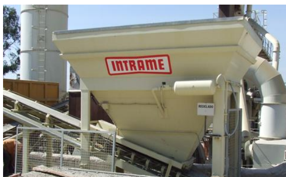
Figura 2.15 - Tolva do material reciclado da central de misturas betuminosas (foto da autora)
