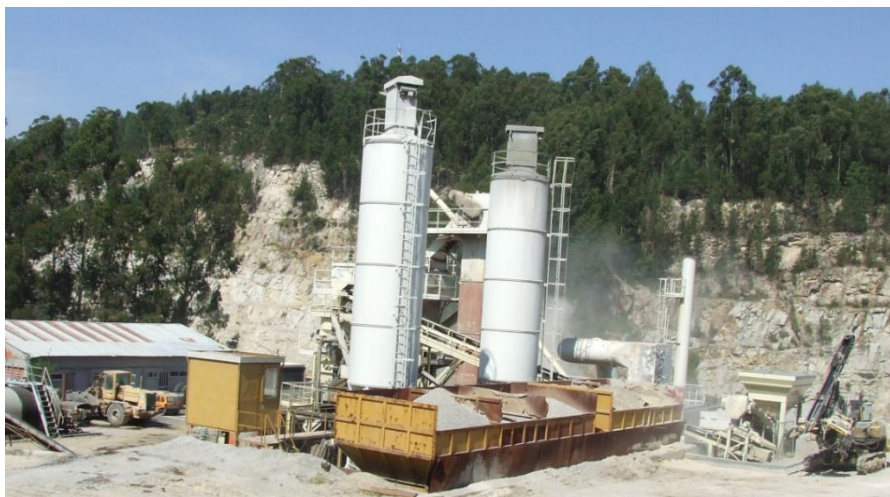
Figura 2.17 - Central de betão hidráulico (foto da autora)
