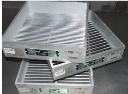
Figura 5.12 - Peneiros utilizados para o índice de achatamento (foto da autora)
