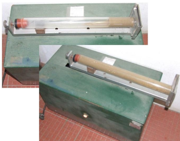
Figura 5.10 - Ensaio do Equivalente de areia (foto da autora)
