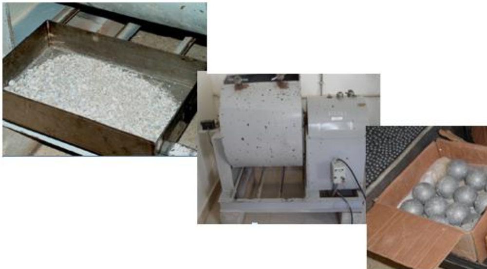
Figura 5.13 - Equipamento do Ensaio Los Angeles (foto da autora )
