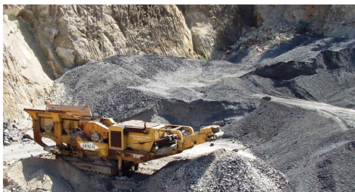
Figura 2.14 - Britador móvel (foto da autora)
