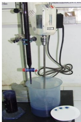
Figura 5.9 - Ensaio do Azul de metileno (foto do autor)
