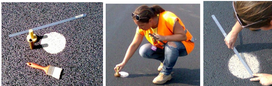
Figura 5.27 - Ensaio da Mancha de Areia (foto da autora)
