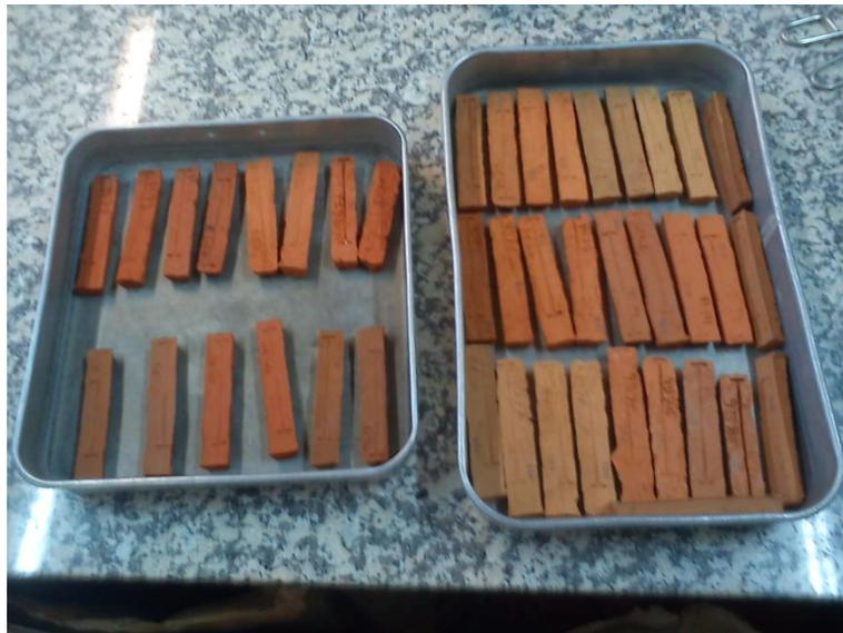
Figura 4.6: Provetes cozidos (com 12 a 15 cm de comprimento) a 850 °C, 950 °C e 1050 °C
