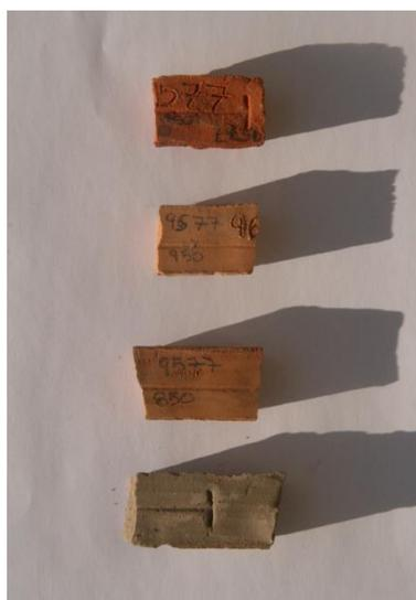
Figura 5.25 Provetes da amostra OB.3.2 (da base para o topo: verde/seco, 850 °C, 950 °C e 1050 °C)
