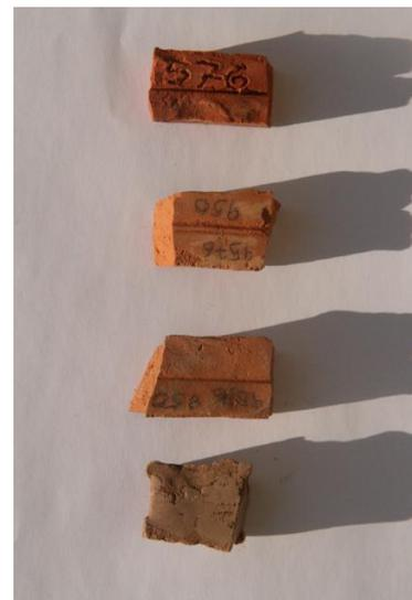
Figura 5.24 Provetes da amostra OB.3.1 (da base para o topo: verde/seco, 850 °C, 950 °C e 1050 °C)
