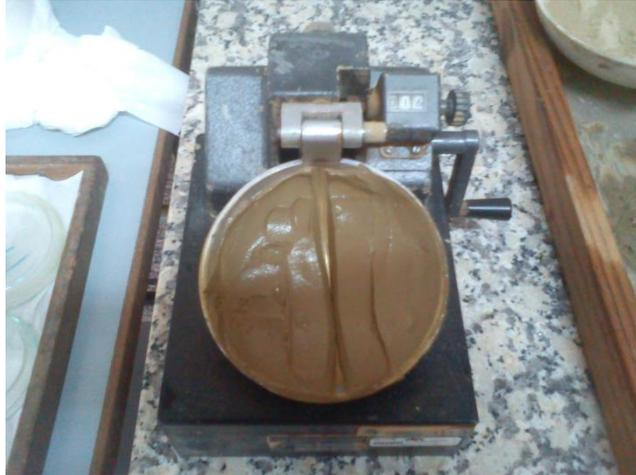
Figura 4. 5: Determinação do limite de liquidez.
