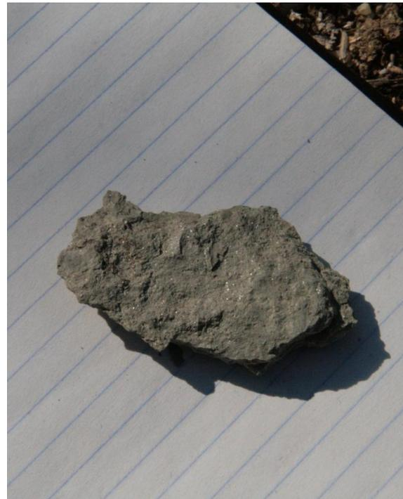
Figura 3.6: Aspecto da amostra colhida em nível siltítico-argiloso cinzento do Barreiro 1 (OB 1.3)
