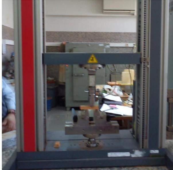
Figura 4.7: Realização do ensaio de resistência mecânica à flexão num provete.
