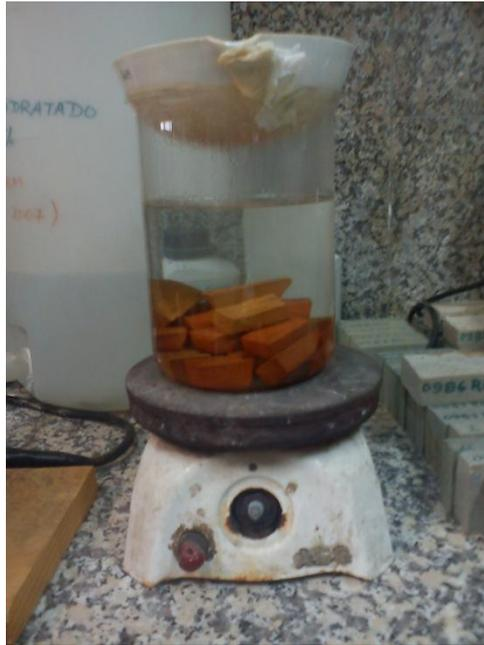
**Figura 4.8: Realização do ensaio de absorção.**
