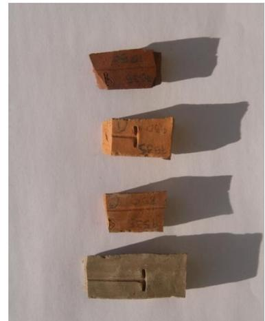
Figura 5.21 Provetes da amostra OB.1.3 (da base para o topo: verde/seco, 850 °C, 950 °C e 1050 °C)
