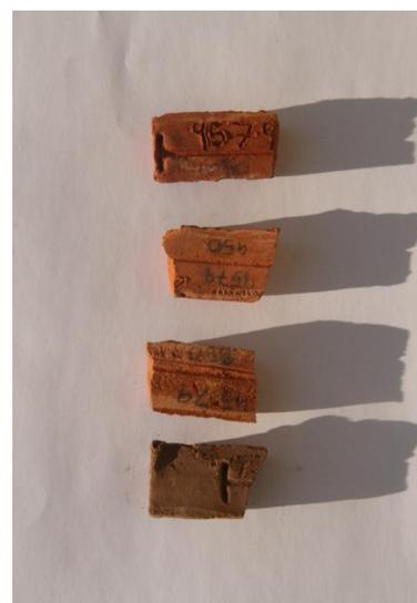
Figura 5.27: Provetes da amostra OB.3.4 (da base para o topo: verde/seco, 850 °C, 950 °C e 1050 °C)
