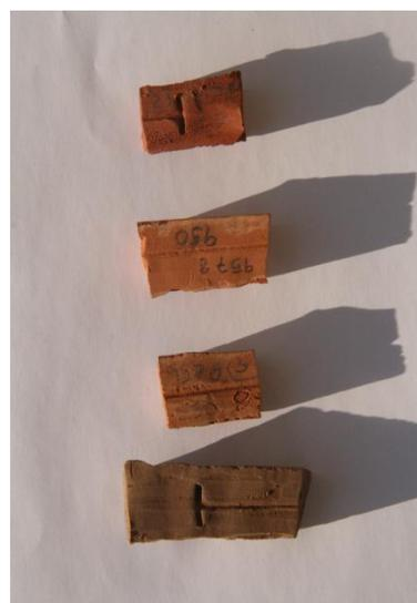
Figura 5.26 Provetes da amostra OB.3.3 (da base para o topo: verde/seco, 850 °C, 950 °C e 1050 °C)
