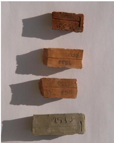
Figura 5.19 Provetes da amostra OB.1.1 (da base para o topo: verde/seco, 850 °C, 950 °C e 1050 °C)
