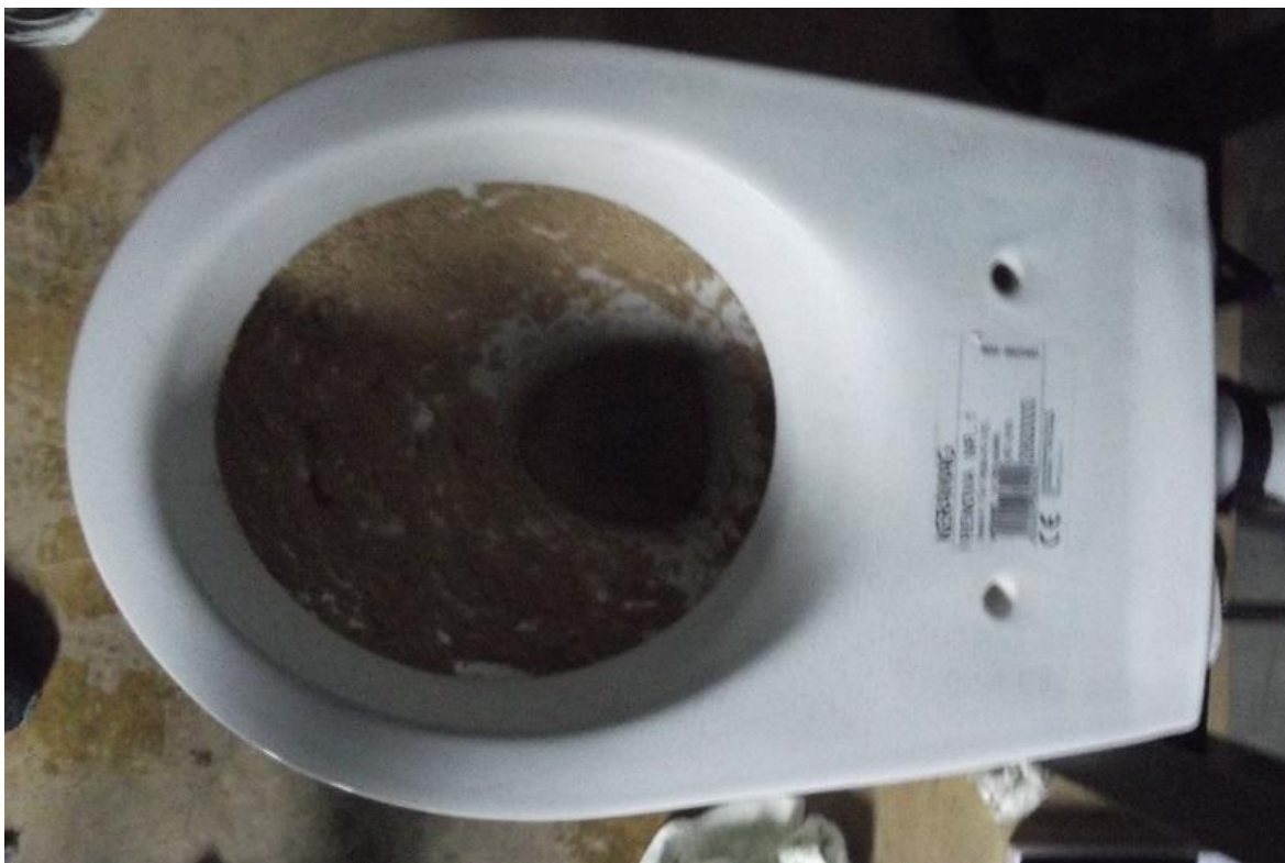
Figura 17. Ensaio da lavagem das paredes do vaso sanitário
