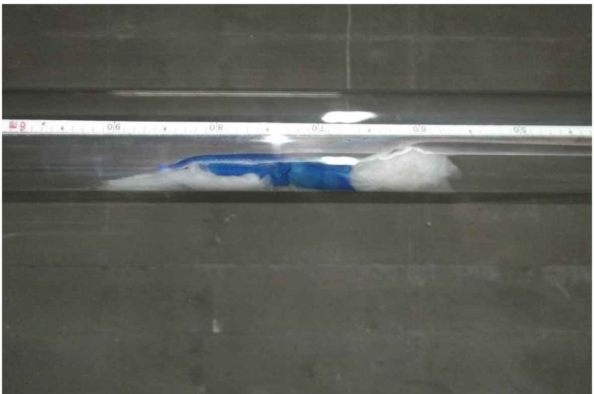
Figura 34. Altura da lâmina líquida a montante do aglomerado depositado no ramal de DN90
