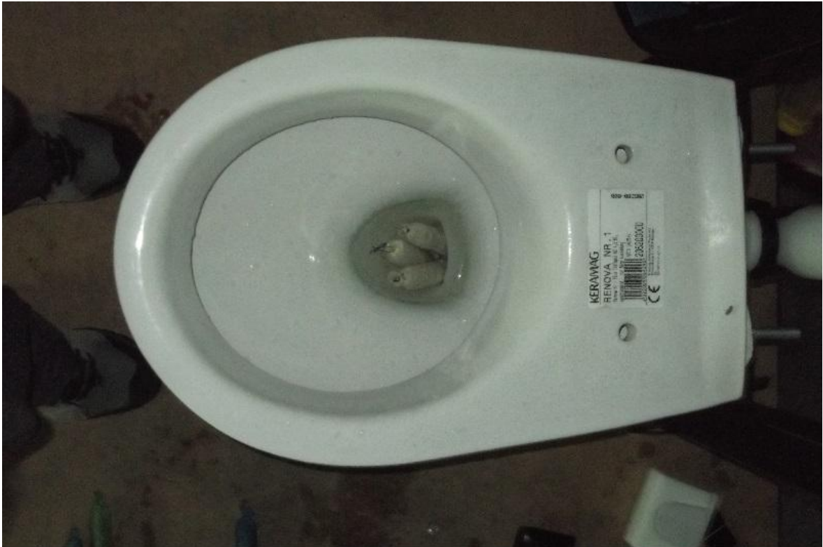
Figura 27. Lançamento dos provetes para o Ensaio de descarga de sólidos e volume após descarga
