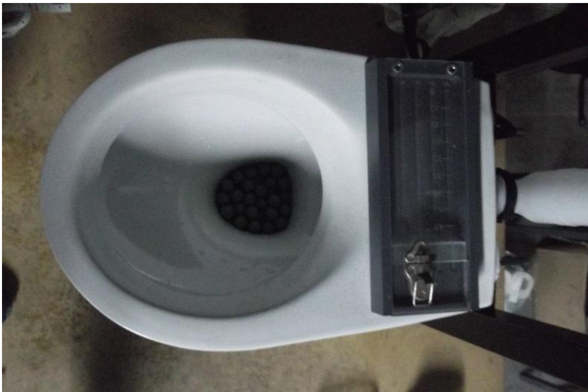
Figura 26. Lançamento das esferas para Ensaio de descarga de cinquenta esferas de plástico
