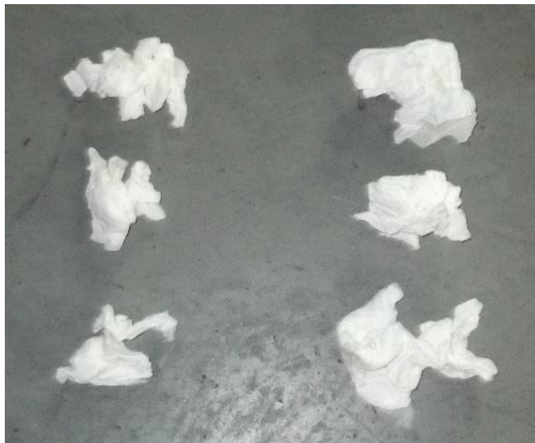
Figura 16. Conjuntos de papel higiênico. À esquerda o conjunto de menor gramagem e à direita o de maior gramagem
