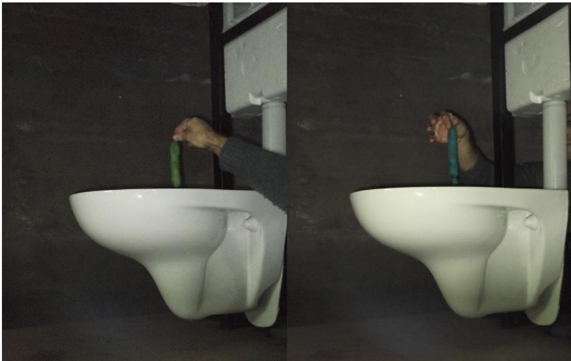
Figura 23. Lançamento dos provetes na sanita (à esquerda 100 g e à direita 160 g)
