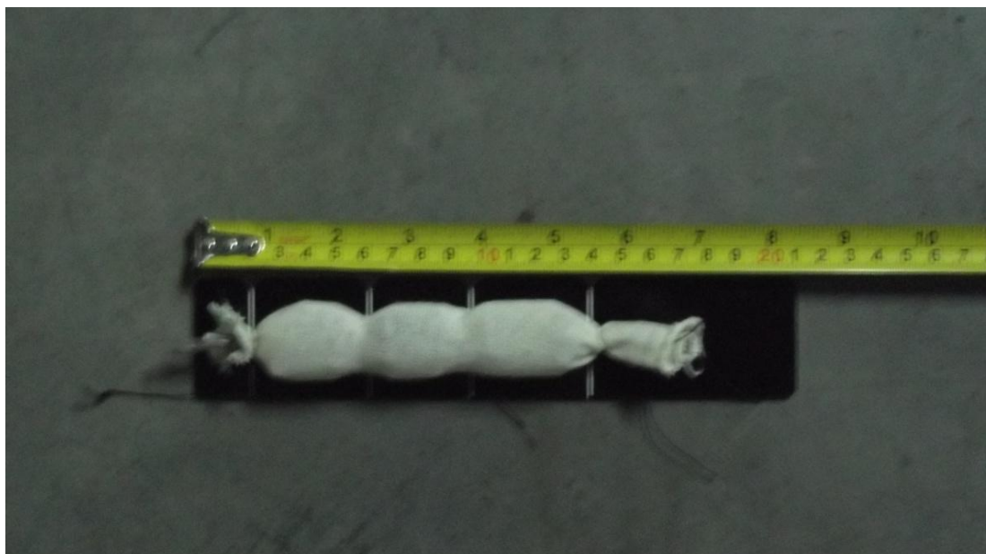
Figura 22. Provete tipo obtido de acordo com a NP EN997
