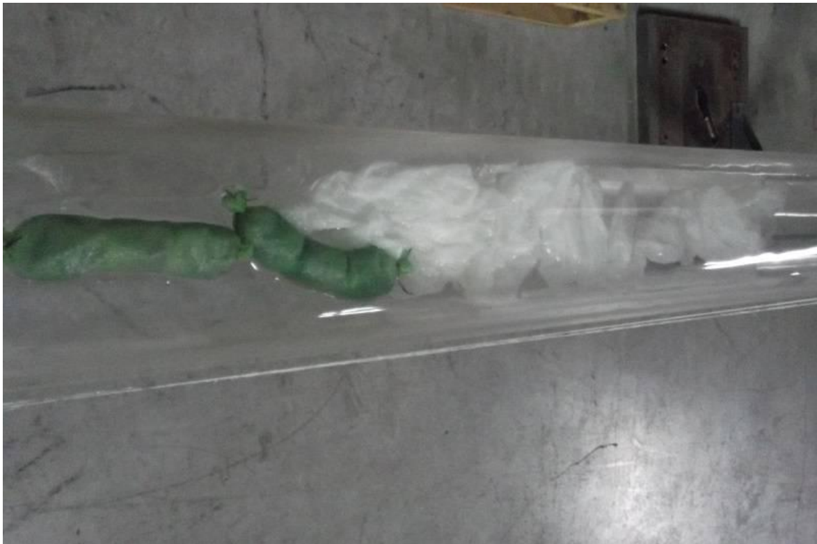
Figura 30. Disposição do aglomerado no ramal com o papel higiênico a montante
