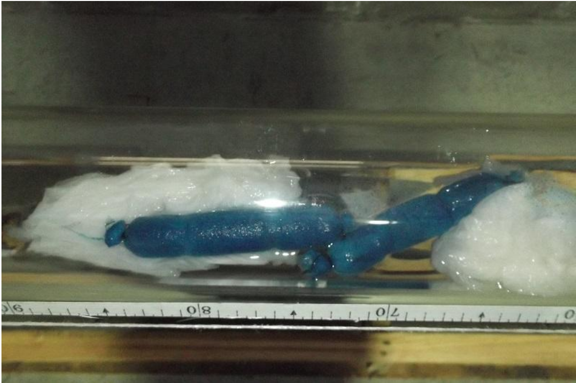
Figura 31. Disposição do aglomerado no ramal com o papel higiênico a jusante e a montante
