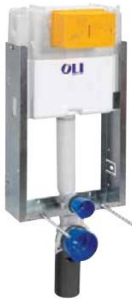
Figura 8. Autoclismo interior “Speed mecânico”, com dupla descarga e volume de descarga regulável, apoiado na estrutura “Simflex” (OLI, 2011)
