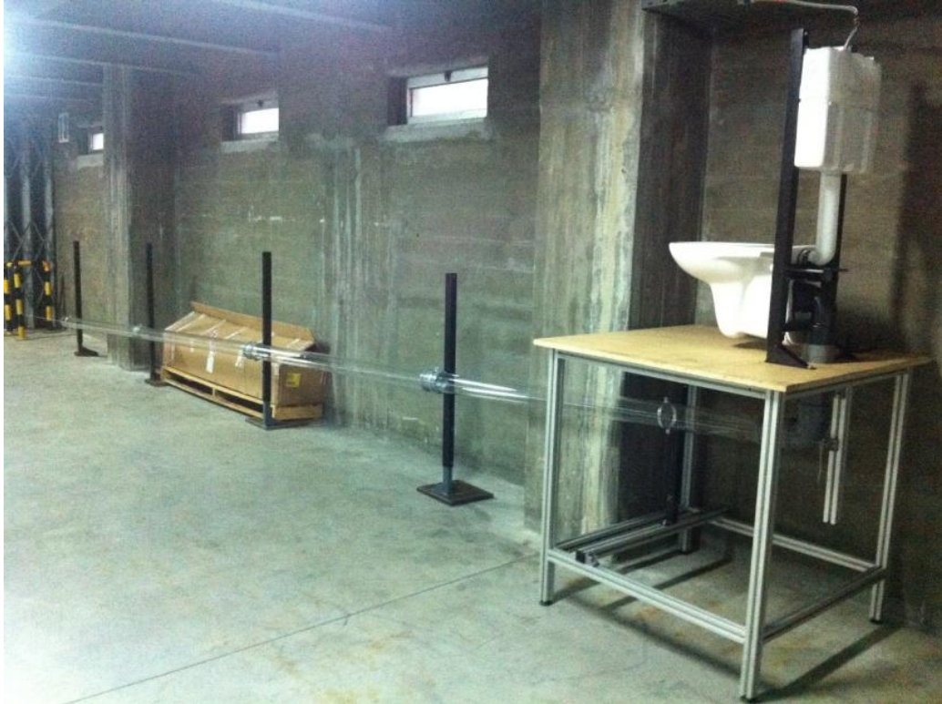
Figura 7. Equipamento de teste. Disposição final do sistema de drenagem
