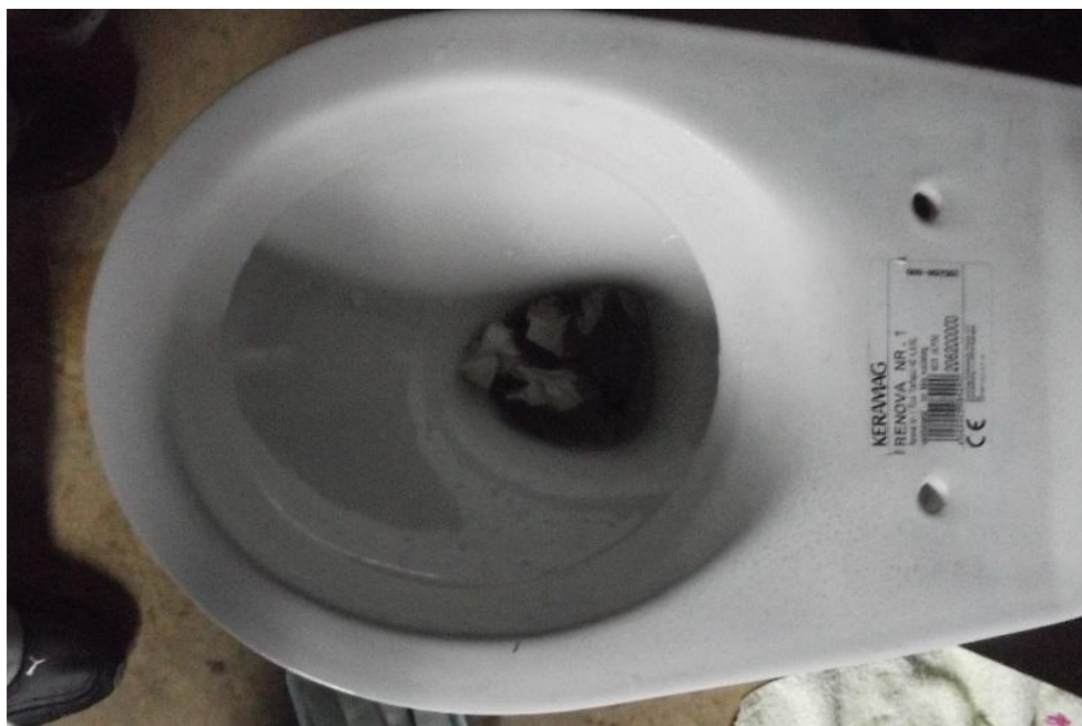
Figura 25. Lançamento das folhas de papel no Ensaio de evacuação do papel higiênico
