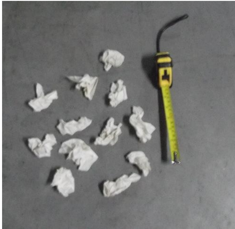
Figura 18. Folhas de papel higiénico para a realização do ensaio de evacuação do papel higiénico
