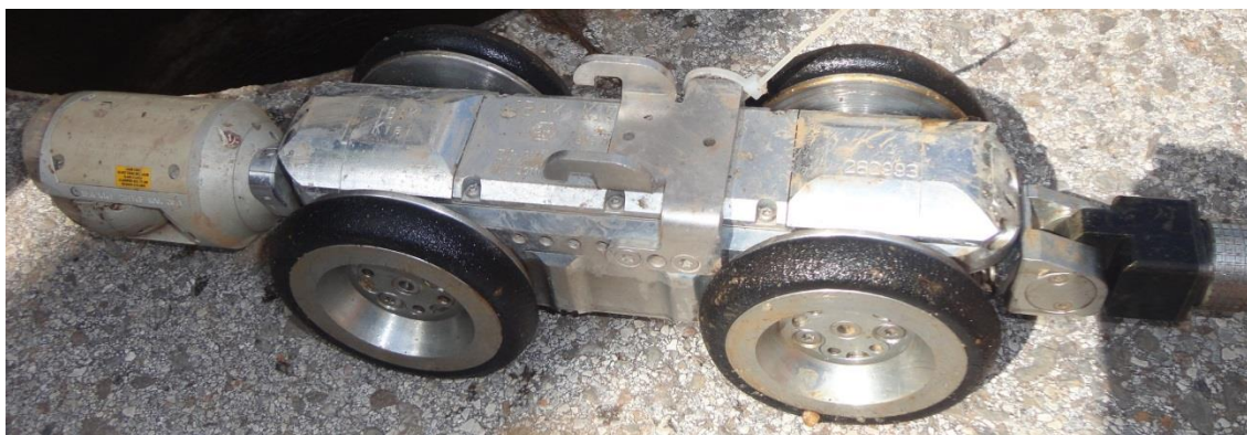
Figura 20 – Robot utilizado no acompanhamento de uma inspeção CCTV.
