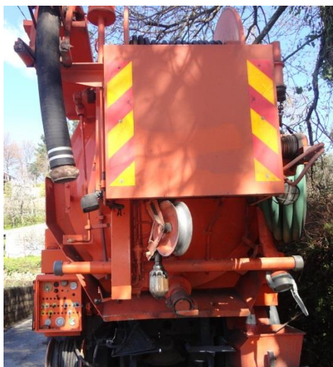
Figura 17 – Camião de limpeza com aspirador de detritos e mangueira.
