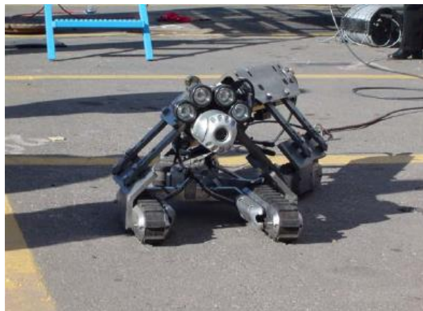
Figura 4 – Câmara de CCTV móvel (Koo e Ariaratnam, 2006).
