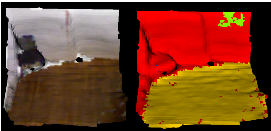
Ilustração 34 - Segmentação da malha poligonal colorida (lado esquerdo) através do HSV e seleção de 3 materiais diferentes para parede, chão e cadeira (lado direito).
