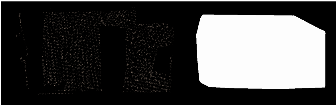
Ilustração 48 - Pontos que pertencem ao mesmo plano após aplicação do algoritmo RANSAC (lado esquerdo) processa o algoritmo que aplica o Convex Hull a esses pontos (lado direito).
