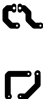
Figura 6.4: PCB para a fonte de alimentação BeagleBone Black.
