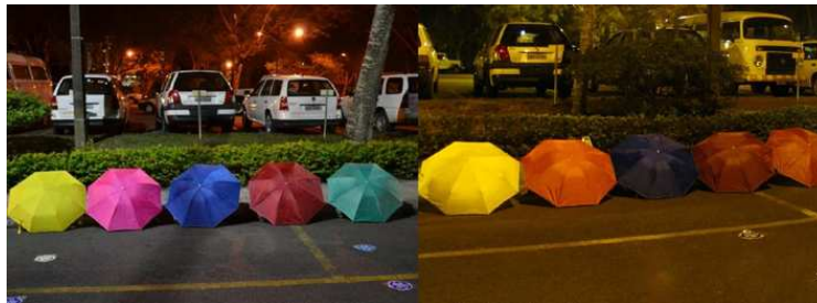
Figura 2.2: Comparação da Reprodução de cores entre duas tecnologias de iluminação distintas. [3].
