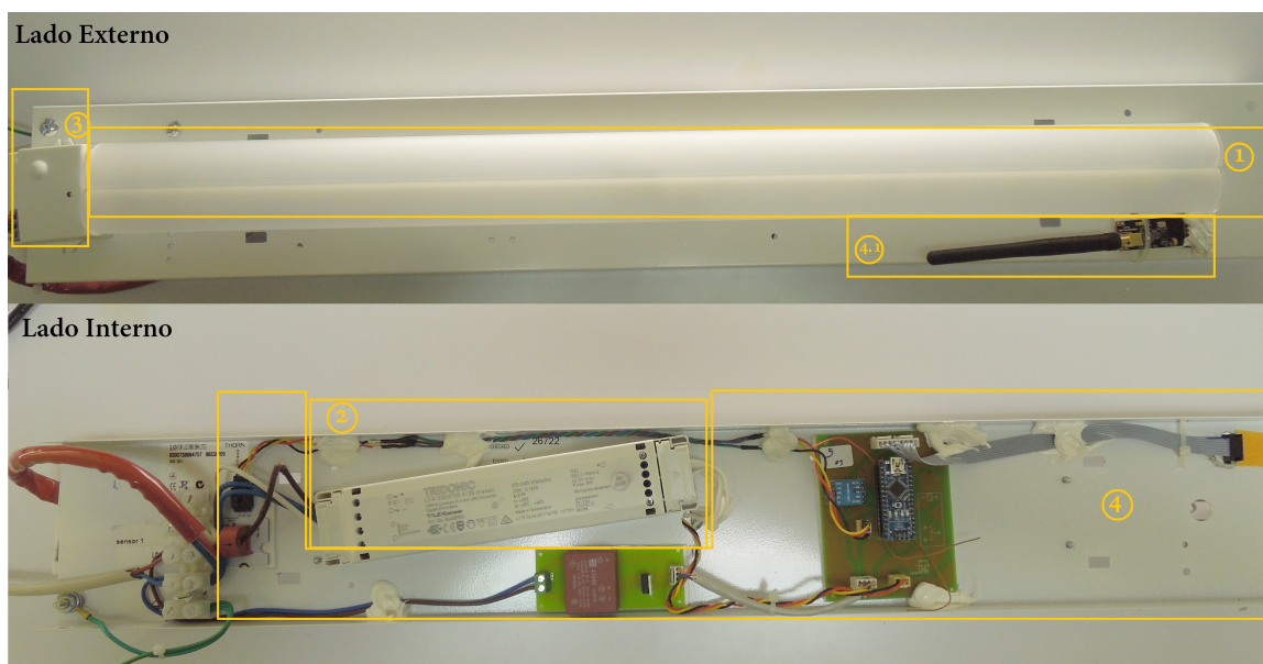
Figura 4.4: Luminária. (Legenda: 1- Unidade de iluminação; 2- Unidade de controlo e alimentação; 3- Sensor de luminosidade e de movimento; 4- Unidade de monitorização e comunicação; 4.1- Rádio pertencente à unidade 4).
