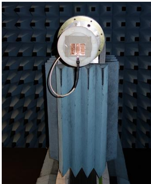
Figura 52- Montagem para a medição do diagrama de radiação
