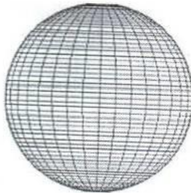
Figura 35- Diagrama de radiação de uma antena isotrópica [37]
