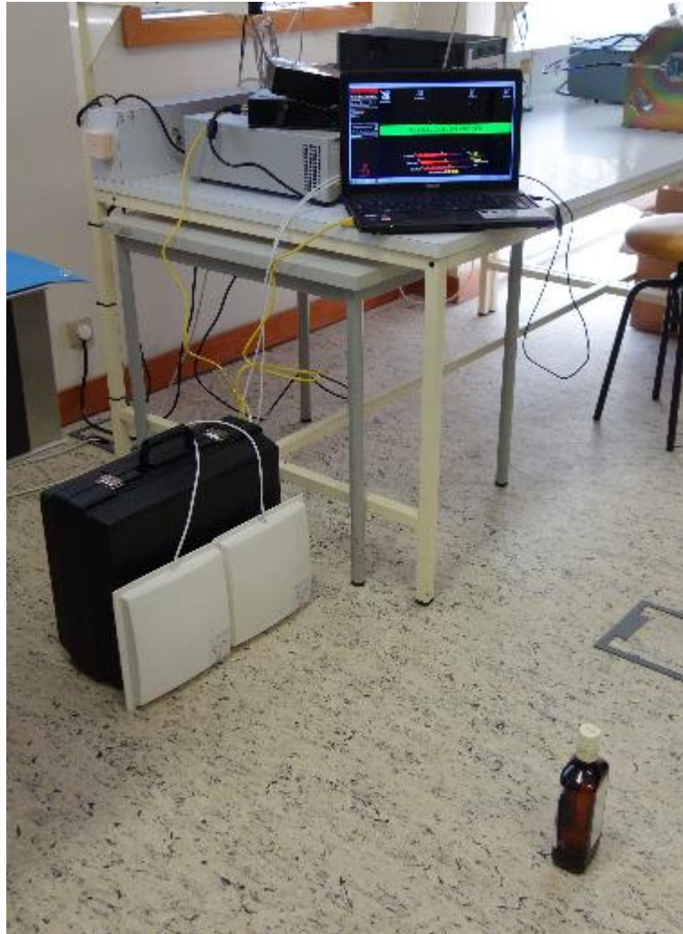
Figura 89- Medição do Alcance de leitura de um rótulo RFID numa garrafa
