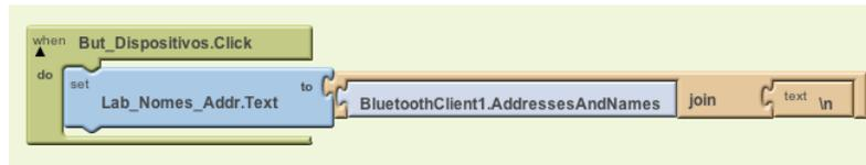
Figura 4.36 – Diagrama de blocos do botão Dispositivos
