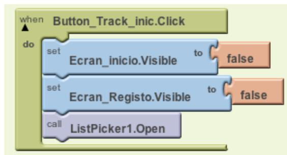
Figura 4.37 – Diagrama de blocos do botão Tracking
