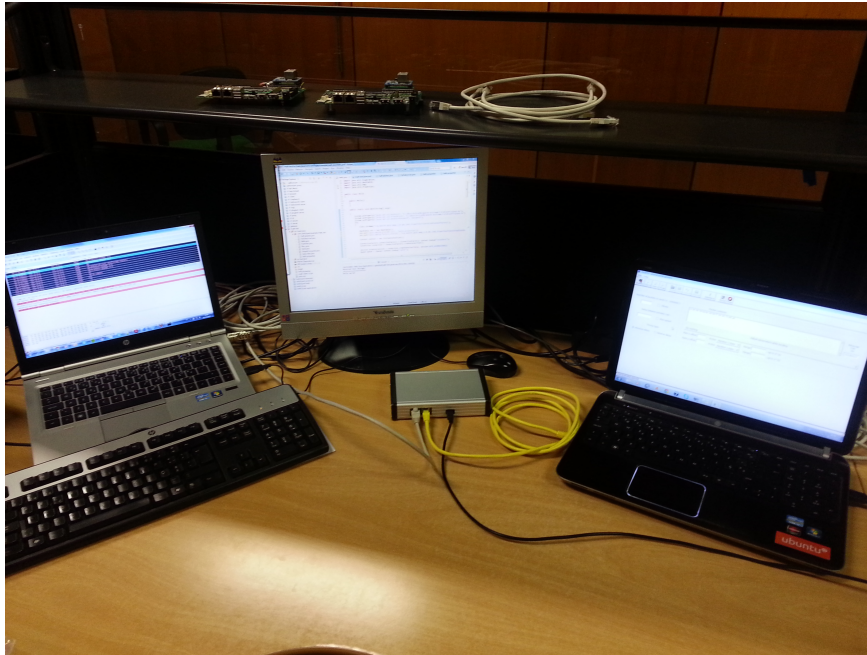
Figura A.1: Sniffer a realizar a captura das tramas entre dois computadores
