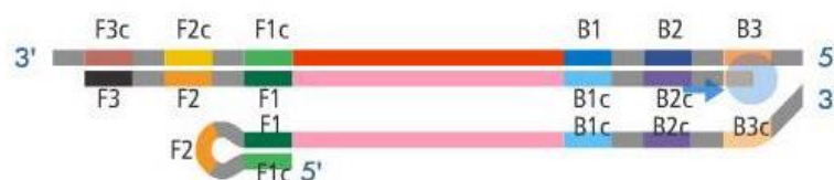
Figura 9 – Emparelhamento das regiões complementares F1 e F1c e consequente formação do loop na cadeia de DNA libertada (adaptado de [63]).
