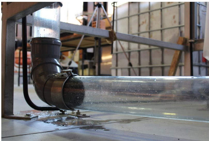
Figura 48 - Duas curvas a 45^\circ com rotação de 43,75^\circ entre elas
