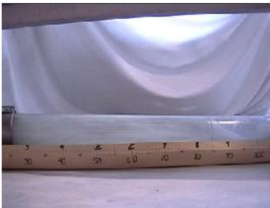
Figura 56 - Comprimento ressalto/regolfo (Tubo aberto, 2 curvas 45º rot. 43,75º)
