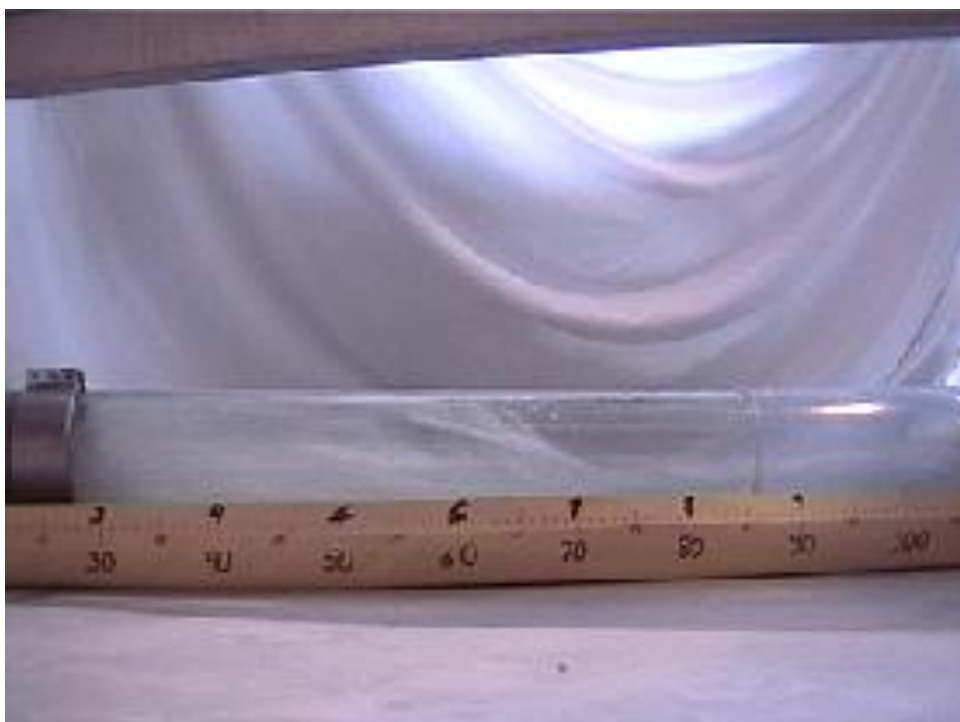
Figura 58 - Comprimento ressalto/regolfo (tubo obstruído, 2 curvas 45°)
