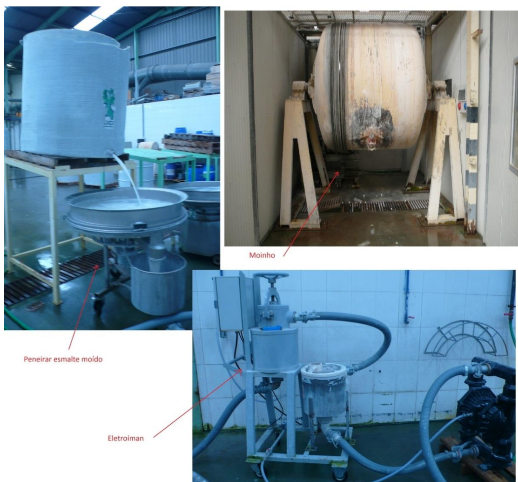
Figura 18 Elementos do processo de descarga de moinhos (moinho, peneiro e eletroímã)
