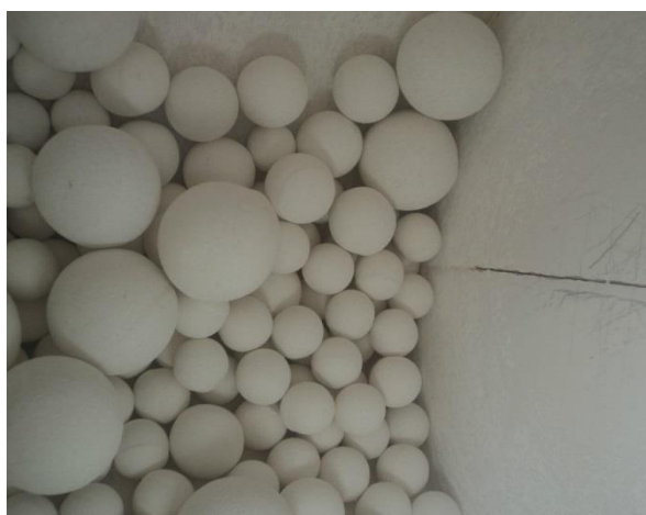
Figura 11 Bolas de alumina dentro de um moinho
