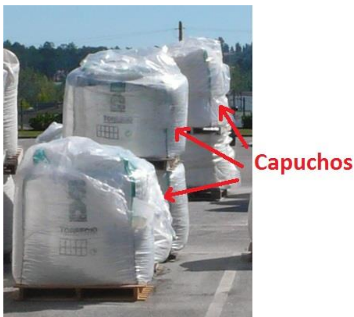
Figura 22 Colocação de capuchos sobre os big bags para os proteger das intempéries
