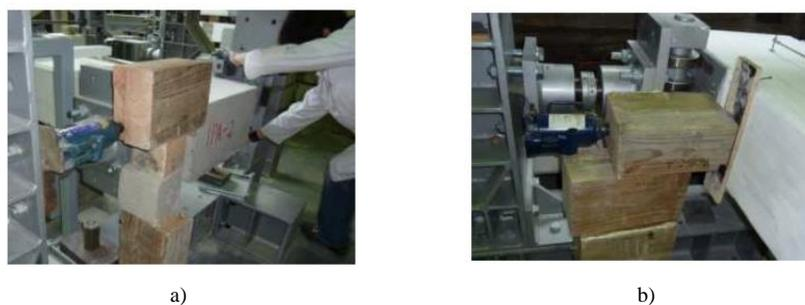
Figura 20 – Aplicação da pré-carga no provete IPA-2: a) viga direita; b) viga esquerda.
