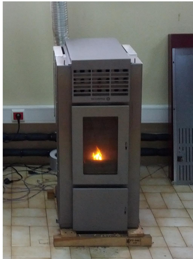
Figura 5.9 – Recuperador de calor em funcionamento.
