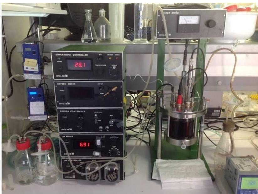
Figura 19: Fotografia do reator e respetivos controladores de pH, oxigénio, temperatura e arejamento.
