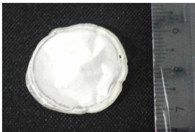
**Figura 17:** Filme de PHA obtido da extração do polímero produzido por *C. necator* em meio EAF.
