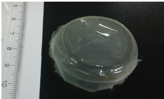
**Figura 9:** Filme de PHA obtido da extração do polímero produzido por *C. necator* em meio MG.
