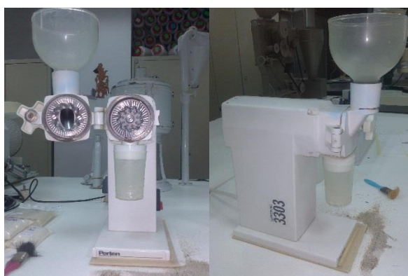
Fig. 10 - Moinho de laboratório utilizado na moagem dos grãos para obtenção das farinhas de arroz.
