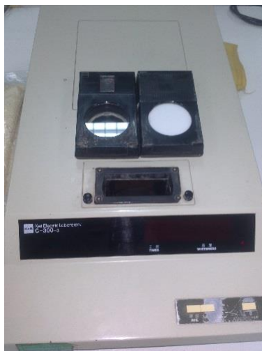
Fig. 12 – Aparelho de Análise de brancura por Kett ( Kett Electric Laboratory, model C300-3 ).
