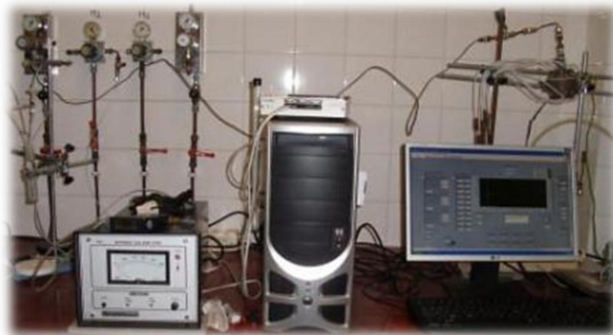
Figura 4.8 - Analisador de CO 2 .
