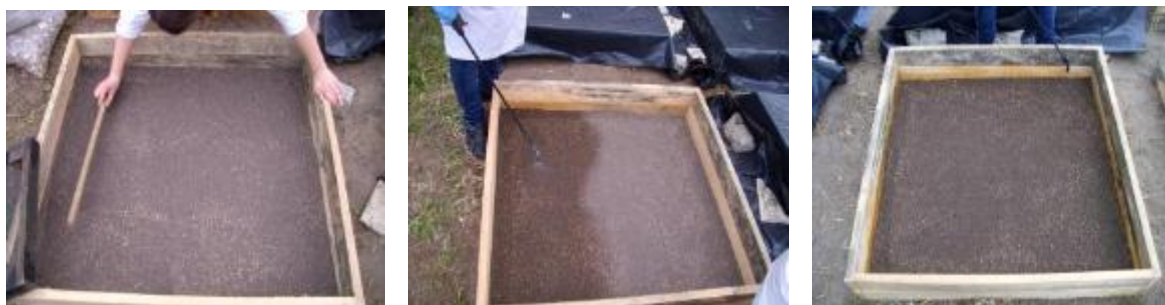
Figura 4.2 - Construção das pilhas de cinza.
